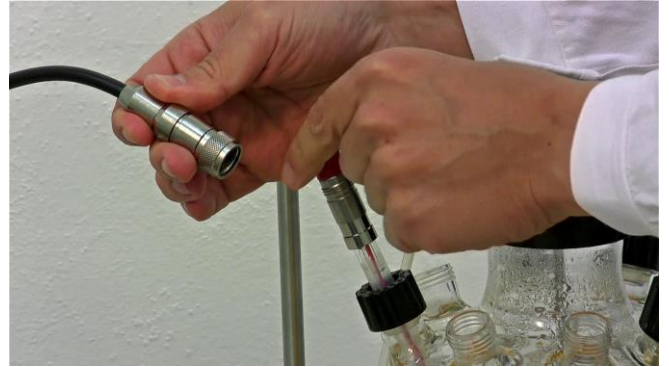
Figura 3.15-6 Retire la tapa protectora roja del electrodo de pH.
