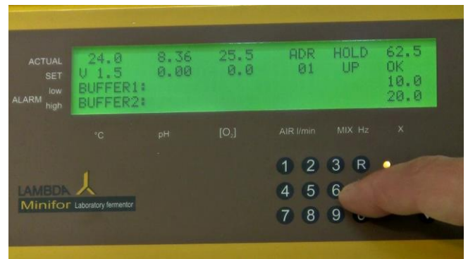
Figura 5.5-12 Espere hasta que aparezca el mensaje "HOLD" y luego presione la tecla de calibración "C". El mensaje "OK" aparecerá indicando que la calibración ha sido aceptada por la unidad del fermentador MINIFOR. Ahora, la escala está calibrada en g o mL. Las calibraciones del peso deben realizarse de acuerdo al peso a ser medido por Ud.
