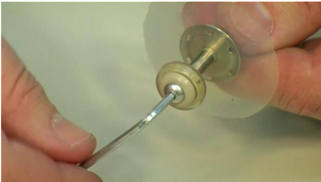
Figura 3.5-23 Se muestra la llave para apretar y asegurar el microdistribuidor de burbujas con auto-limpieza en el extremo del tubo o canal del distribuidor de burbujas.
