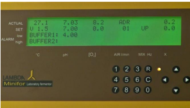
Figura 5.2-13 Espere el valor REAL, cuando la medición en la solución de calibración se estabilice.
