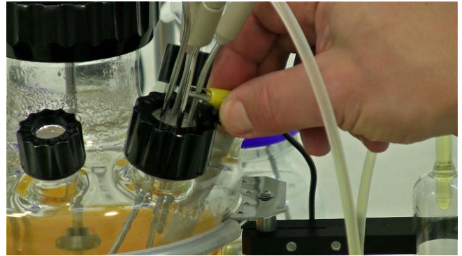
Figura 7.1—4 Quite el cable de conexión a tierra de la cánula del vaso de reacción.
