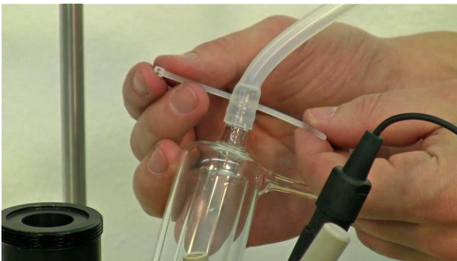
Figura 3.12-4 Selle la tubería o manguera con la "banda de cierre" plástica como se muestra. Es recomendable colocar una pequeña pieza de tubería o manguera cortada verticalmente sobre esta antes del sellado con la "banda de cierre".
