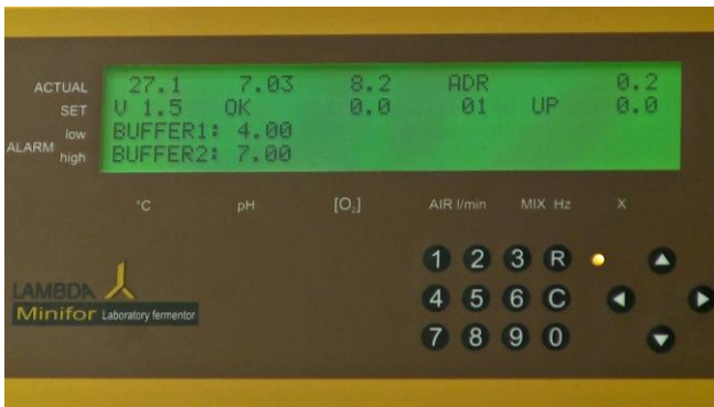
Figura 5.2-15 Si la calibración se realizó correctamente, aparecerá el mensaje OK.
