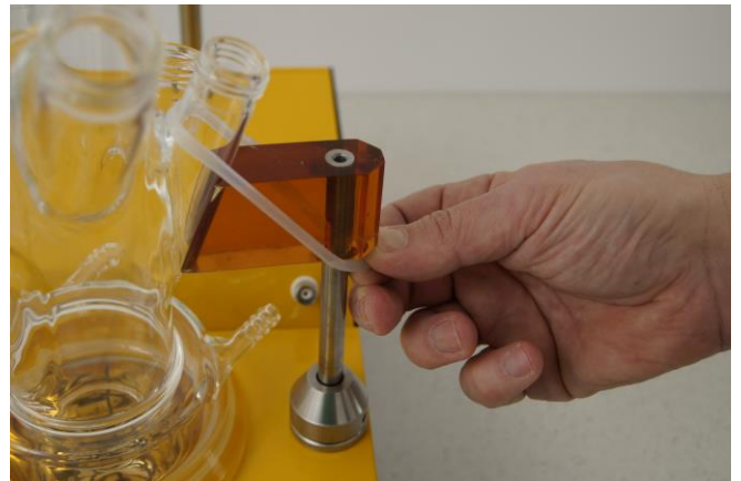
Figura 3.4-18 Estire o hale la junta elástica de silicona y fije los brazos laterales al vaso con el sujetador lateral del vaso de reacción.
