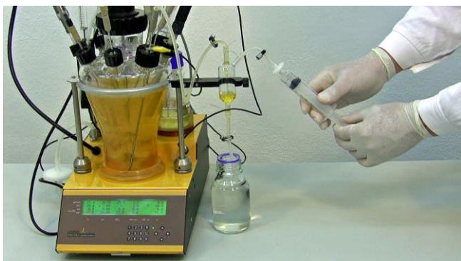
Figura 8.2—3 Hale el émbolo de la jeringuilla para llenar el dispositivo de toma de muestras de vidrio con la muestra del vaso de reacción. Nunca llene el dispositivo de vidrio completamente.
