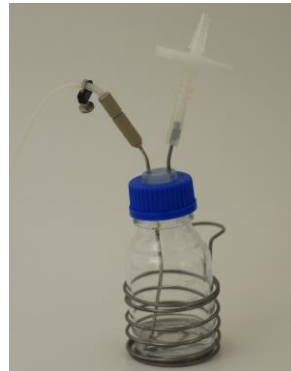
Figura 7.2—2 Pince o cierre la tubería o manguera y compruebe que el filtro no esté obstruido o tupidó. Coloque las botellas en el soporte de las botellas de almacenamiento durante la esterilización.
