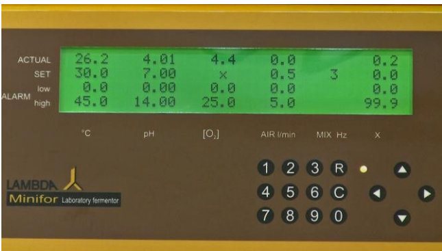
Figura 5.2-23 El valor REAL de pH del parámetro en la pantalla o monitor debe ser 4,00 (Puede variar entre 3,96 a 4,04)
