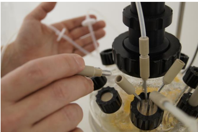
Figura 3.6-13 Conecte la tubería o manguera para la aireación de la superficie a una cánula pequeña hueca en el puerto de muestreo cuádruple que está en el espacio superior o sobre la superficie del medio del MINIFOR.
