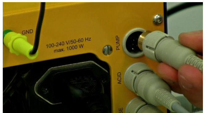
Figura 3.12-15 Conexión del dispositivo de enfriamiento Peltier: en la parte posterior o trasera del MINIFOR.
