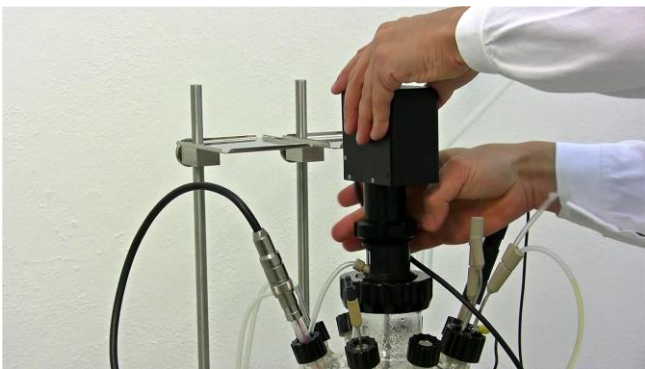
Figura 3.15-3 Toda vez que los imanes o magnetos estén correctamente funcionando, la entrada de aire con la tuerca de acoplamiento móvil de PEEK se desplaza hacia abajo. Asegure el vibromezclador firmemente enroscando la tapa.
