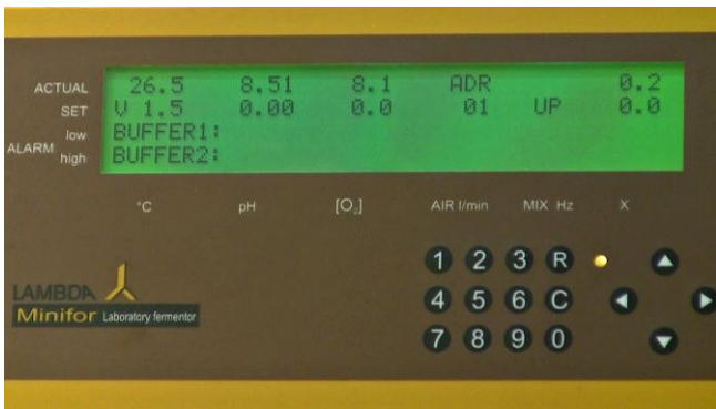
Figura 4.2-3 Modo de calibración – la tecla "C" inicia la calibración del pH, pO 2 , y el parámetro X o el ajuste de la dirección para el control del ordenador o computadora (dependiendo de la elección con el cursor). El LED o indicador está amarillo y la regulación está apagada. (Sólo la agitación es activada para permitir la calibración precisa del electrodo de pO 2 ).
