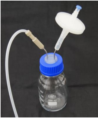
Figura 3.12-1 Botella intermedia entre el condensador del aire y el filtro del aire de salida.
