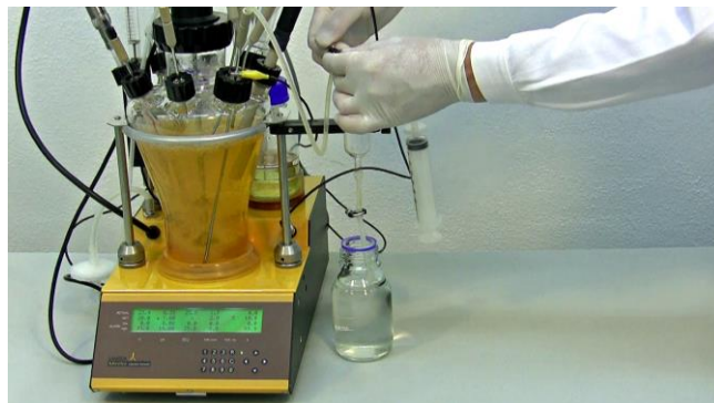
Figura 8.2—2 Abra la pinza en la entrada del puerto de muestreo (es decir, entre el MINIFOR y el dispositivo de toma de muestra).
