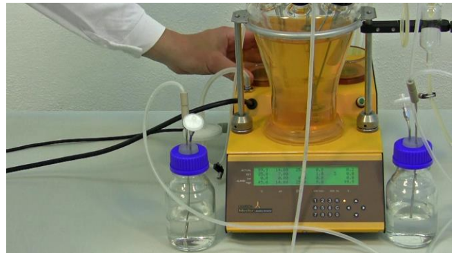
Figura 7.1—10 Almacene o guarde los soportes magnéticos de las botellas en la parte posterior de la unidad principal de control de la base.
