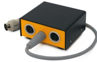
Figura 3.15-10 La caja de enchufe o conector cuádruple puede ser conectada al enchufe o conector de la bomba "PUMP" ubicado en la parte posterior o trasera de la unidad del MINIFOR. El dedo de refrigeración Peltier puede ser conectado a cualquiera de los cuatro enchufes o conectores en la caja de enchufe o conector cuádruple.
