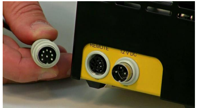
Figura 3.15-12 Conecte un extremo del cable de control remoto al enchufe o conector correspondiente "REMOTE" de la parte posterior o trasera de la bomba peristáltica LAMBDA o Massflow.
