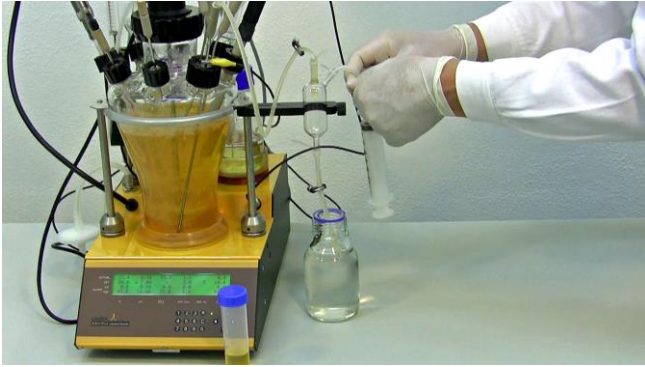
Figura 8.2—13 Toda vez que el muestreo haya terminado, coloque la tubería o manguera de salida en una solución de Etanol al 70% y cierre todas las pinzas en el dispositivo de muestreo.
