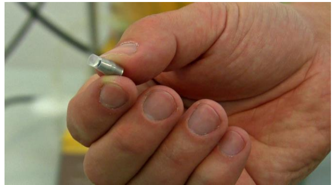
Figura 3.10-12 El septum o tabique tubular (el cual esta sellado en uno de los extremos) debe ser fijado sobre el inserto o pieza metálica cónica con doble sello con el uso de, por ejemplo, una regla dura dejando parte del septum o tabique tubular libre y expuesta como se muestra.
