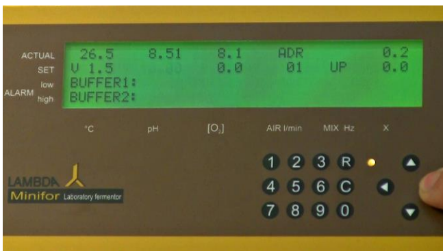
Figura 5.5-3 Cuando el cursor se active, utilice la tecla de navegación derecha (>) para elegir el parámetro "X".
