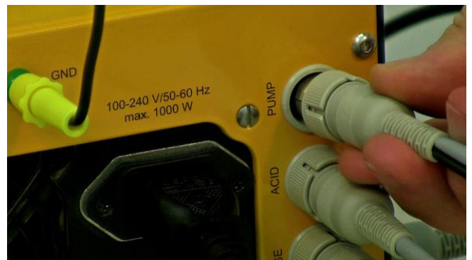
Figura 3.16-19 Otras bombas adicionales pueden ser conectadas al enchufe o conector de la bomba PUMP.
