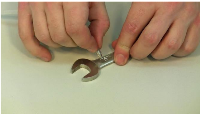
Figura 3.10-9 Tome la llave inglesa y el inserto o pieza metálica cónica de doble sellado con la tubería o manguera. Presione el inserto con la tubería o manguera contra la llave inglesa para insertarlo totalmente dentro de esta.
