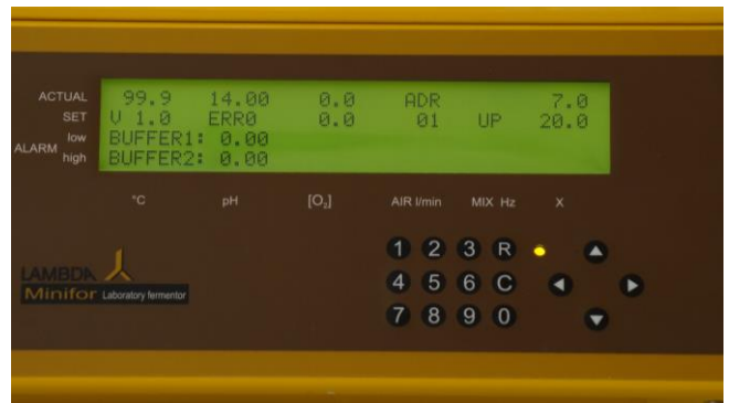
Figura 5.2-16 Mensajes que pueden aparecer: OK- Calibración exitosa ERR0 – significa que la solución de calibración se usó dos veces ERR1 – Significa que el mismo valor se introdujo dos veces Si aparece el mensaje de error, la calibración tiene que ser repetida nuevamente desde el principio.
