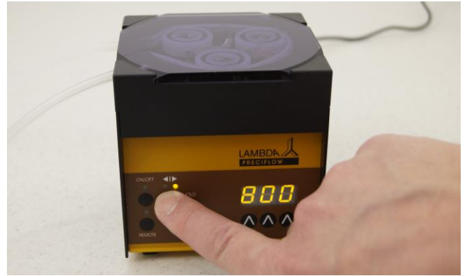
Figura 3.16-13 El LED o indicador de iluminación señalando la dirección ▶ significa rotación en la dirección contraria a las manecillas del reloj.
