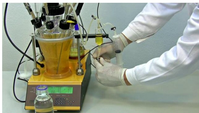
Figura 8.2—6 Abra la pinza de la manguera de salida.
