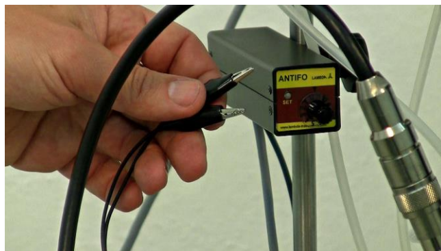
Figura 3.14-2 Las dos pinzas tipo cocodrilo del ANTIFO necesitan ser conectadas con las cánulas a partir del puerto de muestreo cuádruple para la detección del nivel de espuma en el vaso de trabajo.
