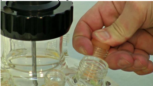
Figura 3.7-5 Inserte el tapón de goma coloreado para el electrodo de pO 2 (OD) en el lado derecho del puerto que está cerca del puerto de muestreo (diámetro mayor)
