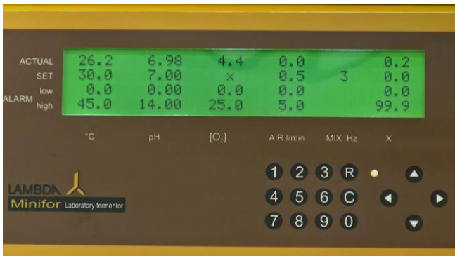
Figura 5.2-17 Después de presionar la tecla de regulación "R", el MINIFOR cambiará del modo de calibración al modo de espera o reposo. Note que el MINIFOR en modo de espera o reposo o en el modo de operación sin bombas se activa.
