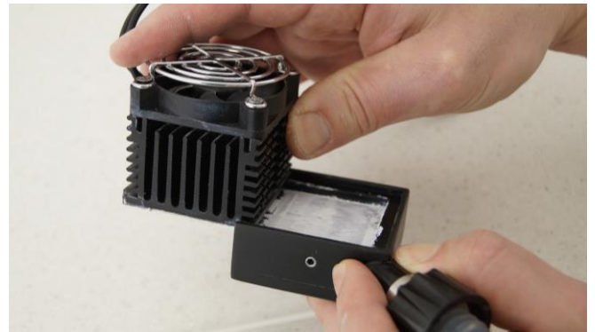
Figura 3.12-9 Una el elemento de enfriamiento Peltier con los componentes electrónicos de control y el ventilador con el dedo de condensación colocando la superficie blanca con la pasta conductora de calor en la trampa respectiva en la unión del dedo de condensación como se muestra.
