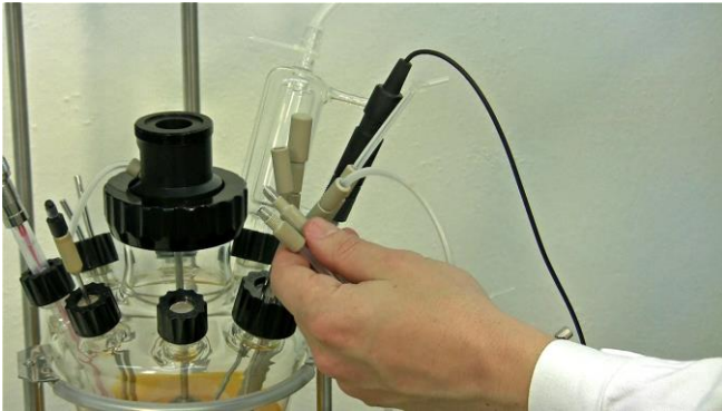
Figura 3.10-27 Tome la tubería preparada con los conectores de tubería de PEEK con doble sello en ambos extremos de la tubería o manguera (refiérase a 3.10.2 Preparación de los conectores de PEEK de tubería o manguera con doble sello).
