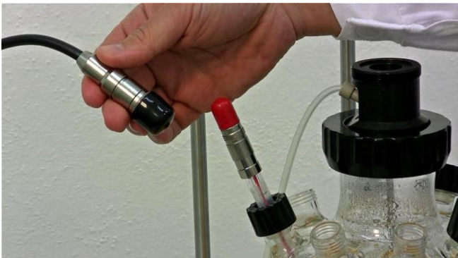
Figura 3.8-9 Tome el conector del electrodo de pH de la unidad principal de control del biorreactor MINIFOR. (Cable negro de la unidad).
