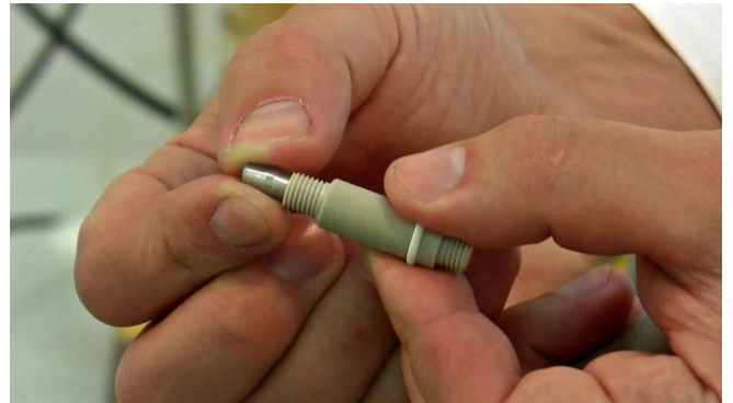
Figura 3.10-14 Note que el sellado del extremo del septum o tabique tubular debe ser fijado dentro del cuerpo adaptador de septum o tabique (en la otra cara de la junta tórica blanca de septum o tabique) como se muestra.
