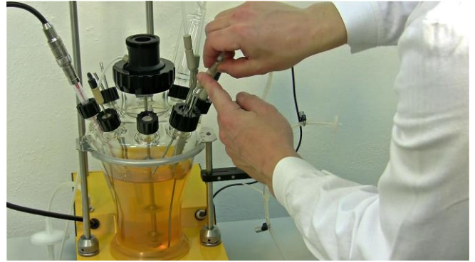
Figura 3.10-26 Tome la tubería o manguera de PEEK con doble sello del dispositivo de muestreo estéril y conéctelo a la cánula más larga en el puerto de muestreo cuádruple.
