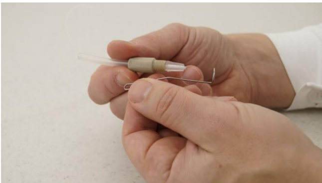
Figura 3.14-9 Inserte el sostenedor para autoclavar el cuello con rosca de la parte de PEEK con doble sello que se ajusta.
