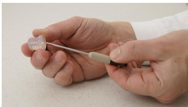
Figura 3.9-3 Inserte la válvula de seguridad limitante de sobrepresión ensamblada al tapón de goma.
