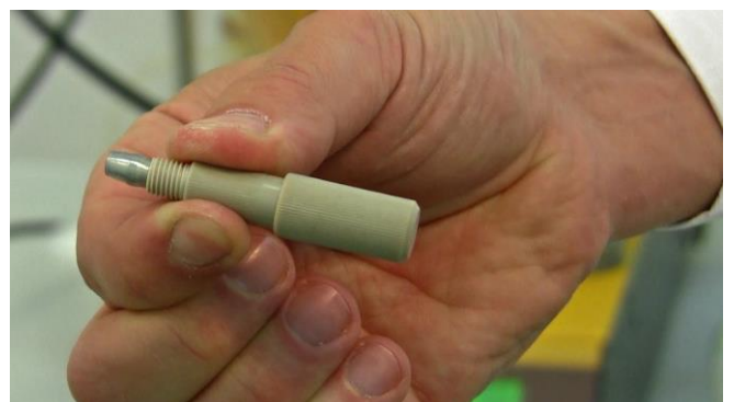
Figura 3.10-16 Juego completo para la inoculación. El extremo libre con el inserto o pieza cónica con doble sello tiene que ser insertado en una de las cánulas o agujas del puerto de muestreo cuádruple.
