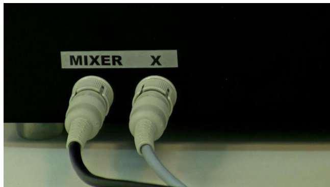
Figura 3.13-4 Inserte el conector y ajústelo de manera segura por medio del enrosque de la manga ajustable presente en el conector.
