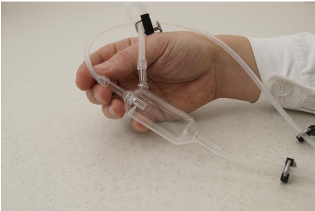
Figure 3.10-21 La tubería con el inserto o pieza de PEEK de doble sellado necesita ser conectada con el dispositivo de muestreo estéril (refiérase a 3.10.2). Preparación de los conectores de PEEK de doble sellado LAMBDA. El acceso (brazo) de entrada para conectar la tubería con pieza PEEK con doble sello tiene una tubería de acceso bien adentro de la parte del dispositivo de vidrio (refiérase a la figura).
