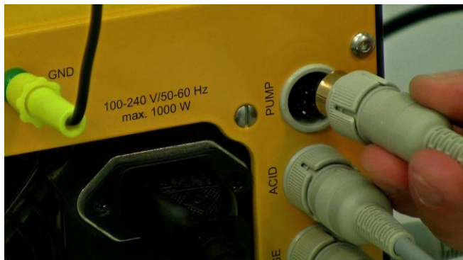
Figura 3.11-15 Conexión del dispositivo de enfriamiento Peltier: en la parte posterior o trasera del MINIFOR.
