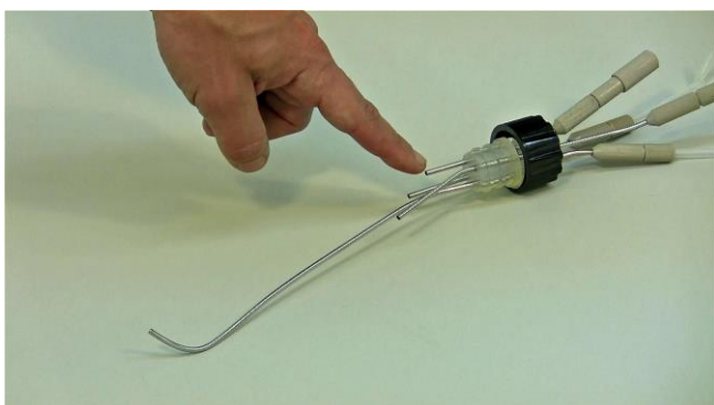
Figura 3.14-5 La segunda pinza tipo cocodrilo (espuma) puede ser conectada a cualquiera de las 3 agujas cortas del puerto de muestreo cuádruple.
