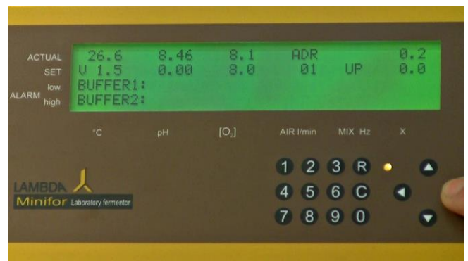
Figura 5.3-6 Cuando la tecla de la flecha derecha (>) haya sido presionada, se guardará o salvará el valor (ej., 8.0).
