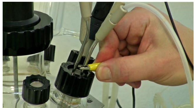
Figura 3.15-37 Coloque la pinza en la otra cara del cable de conexión a tierra con la pinza de tipo cocodrilo amarilla en la cánula más extensa del puerto de muestra cuádruple.
