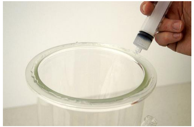
Figura 3.4-24 Aplique la mezcla en todo el borde de la circunferencia de la parte inferior de vaso como un "espagueti".
