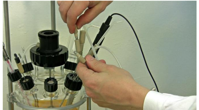
Figura 3.10-28 Conecte un extremo de la tubería o manguera preparada con el conector de la tubería o manguera de PEEK con doble sello a la cánula corta en el puerto de muestreo cuádruple.
