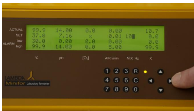
Figura 4.3-5 Mueva el cursor usando la tecla de navegación y colóquelo sobre la columna del MIX Hz. Ajuste la frecuencia deseada de la agitación con las teclas de números y presione o pulse la flecha de la derecha para guardar o salvar el valor introducido.
