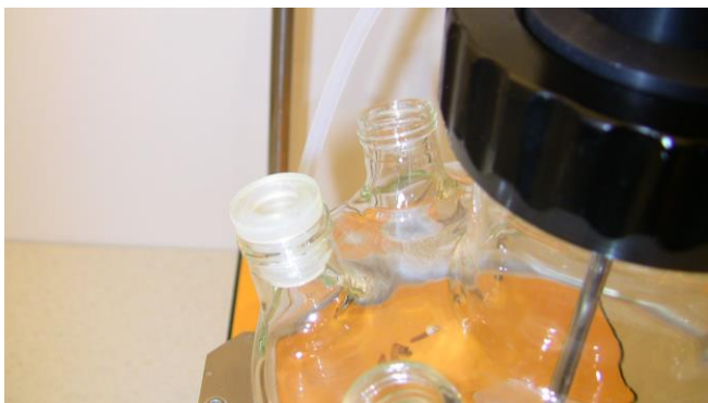
Figura 3.8-3 Coloque cualquiera de los tapones blancos huecos en el puerto opuesto al puerto del electrodo de pO_2 .
