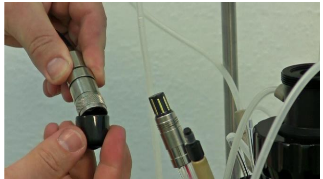
Figura 7.1—8 Proteja el conector del cable “hembra”: usando una tapa contra contaminación.
