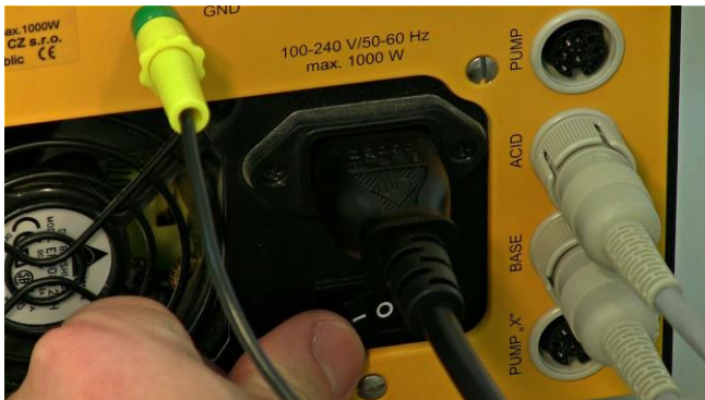
Figura 3.15-44 Cuando las conexiones e instalaciones hayan sido realizadas, encienda el MINIFOR usando el interruptor para el suministro de energía ubicado debajo de la entrada de energía o corriente. (Interruptor de encendido: I = On; O = Off).
