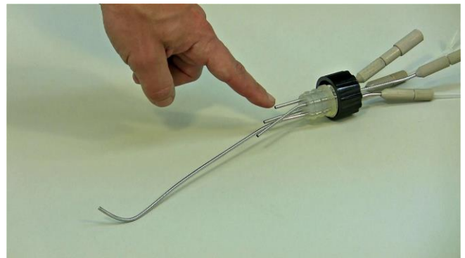
Figura 3.15-30 La segunda pinza tipo cocodrilo (espuma) puede ser conectada a cualquiera de las 3 agujas cortas del puerto de muestreo cuádruple.
