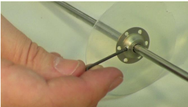
Figura 3.5-21 Ajuste y apriete las “colas de pescado” en el tubo del distribuidor de burbujas con una de las llaves suministradas por el fabricante. (ej. la pieza con roscas debe estar de frente y hacia abajo para todas las “colas de pescado”).
