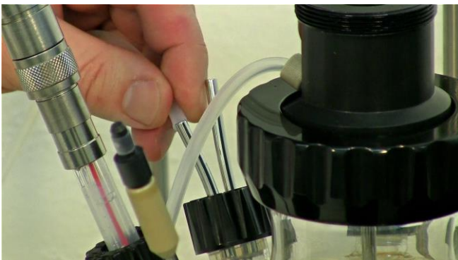
Figura 3.11-5 Deslice la tubería o manguera para la entrada del líquido de enfriamiento sobre uno de los tubos verticales del lazo (bucle o serpentín) de enfriamiento como se muestra.
