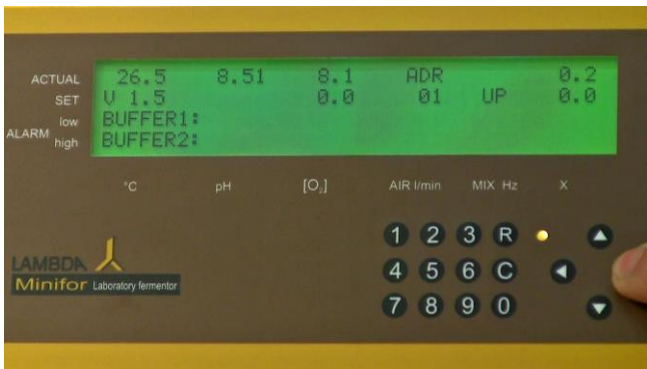
Figura 5.3-3 Mueva el cursor hacia el valor de [O 2 ] utilizando la tecla de navegación derecha (>).
