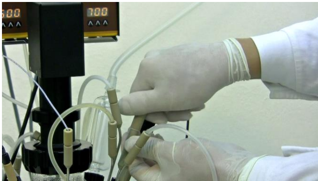
Figura 8.2—1 Como primer paso, afloje o libere la tapa de protección del septum o tabique.
