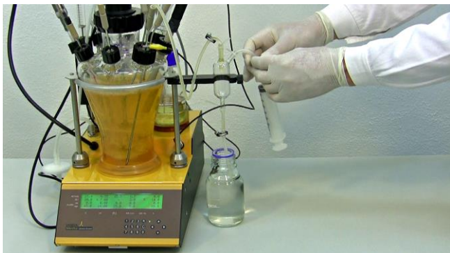
Figura 8.2—1 Abra la pinza de la tubería o manguera que se conecta con la jeringuilla.
