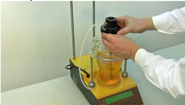
Figura 3.5-25 Ponga la unidad de agitación con los discos de “colas de pescado” y el microdistribuidor de burbujas dentro del vaso y fije la tapa con rosca central sobre el vaso de reacción.
