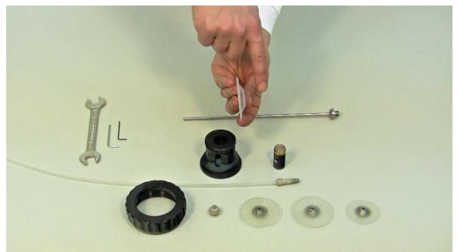
Figura 3.5-12 Tome la membrana estéril de silicona de manera que la superficie convexa de la membrana esté orientada hacia fuera y la cóncava hacia el interior (como se muestra en la figura).
