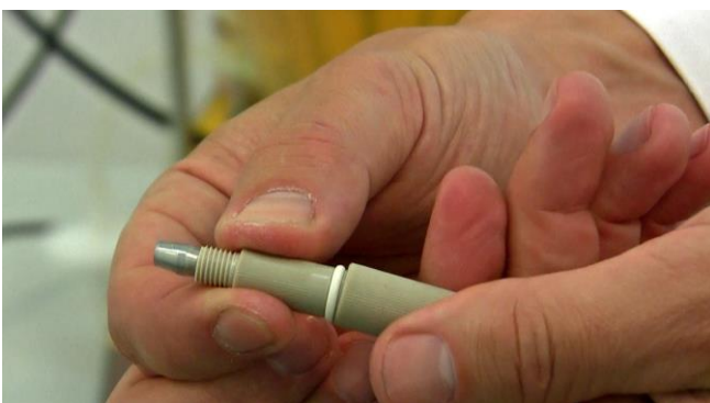
Figura 3.10-15 Fije la tapa protectora del septum o tabique en la cara con rosca de la junta tórica blanca de septum o tabique.
