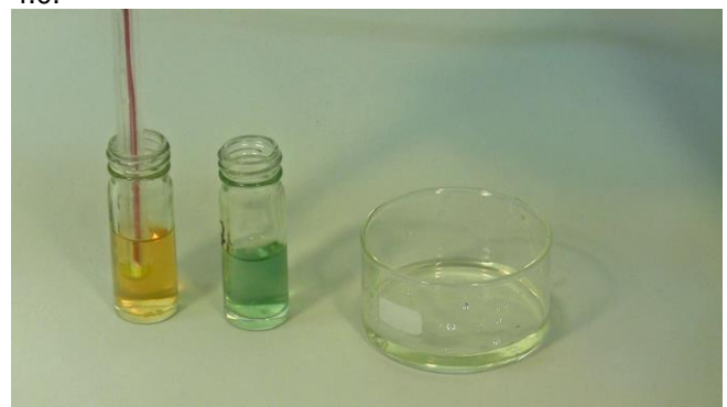
Figura 5.2-6 Sumerja el electrodo en la solución de calibración (solución tampón de pH 4,0) y agítelo suavemente mientras mide el pH.
