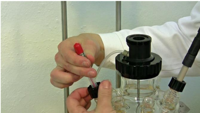
Figura 3.8-7 Inserte cuidadosamente el electrodo de pH en el puerto preparado con el tapón hueco, la arandela y la tapa negra con rosca.
