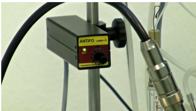
Figura 3.14-1 ANTIFO (detector y controlador de espuma). Coloque el parte principal del ANTIFO en una de las varillas de apoyo del biorreactor / fermentador de laboratorio MINIFOR (ej. Bajo una bomba que esté unida al soporte). De esta manera, será accesible y ocupará un mínimo de espacio.
