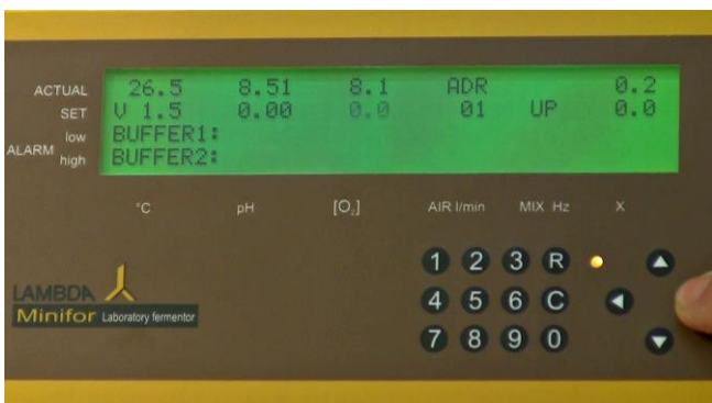
Figura 4.1-6 Una vez que el cursor se active después de la pulsación larga de la tecla "C", al pulsar las flechas, el cursor se moverá en la dirección correspondiente.
