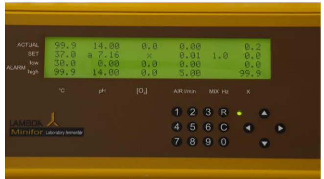
Figura 4.2-2 Modo de regulación / operación - La regulación se activa pulsando la tecla "R" y el LED o indicador cambiará a verde. La pantalla o monitor mostrará la medición de todos los parámetros.
