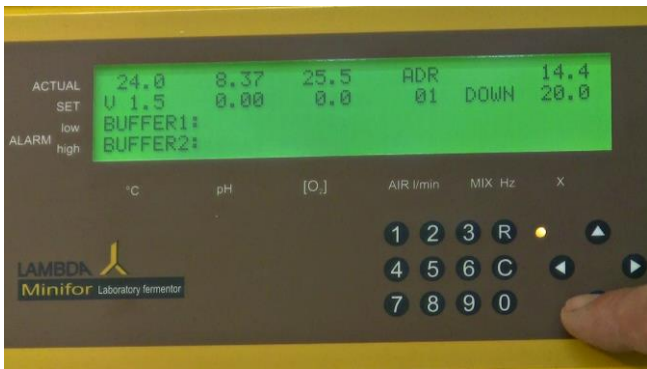
Figura 5.5-16 Utilice la tecla de navegación abajo para cambiar a la opción de abajo (DOWN).
