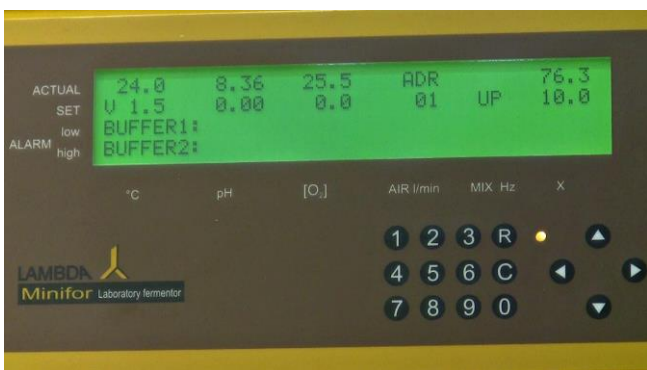
Figura 5.5-5 El valor introducido de 100 aparecerá como 10,0 en la pantalla (en la fila de valores SET) después de presionar la tecla de flecha derecha.
