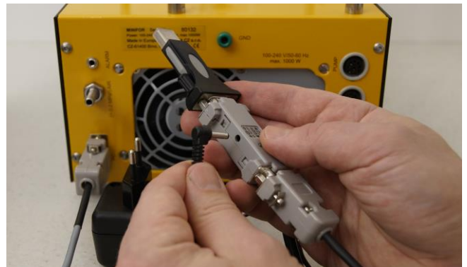
Figura 6.4—4 Enchufe o conecte la fuente de energía para el convertidor de RS-232 a RS-485.
