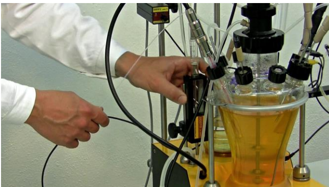
Figura 3.14-23 Coloque el DOZITO en la unidad principal del MINIFOR con la ayuda del soporte magnético en el DOZITO.
