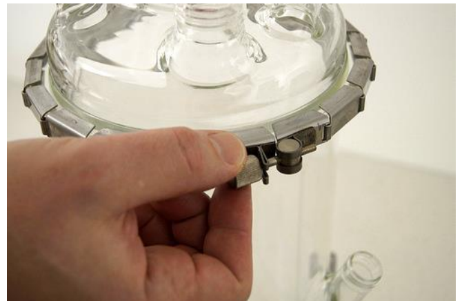
Figura 3.4-28 Fije ambas partes con el cinturón de cierre segmentado.
