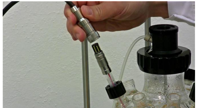
Figura 3.8-10 Retire la tapa protectora negra de la parte del sensor (parte superior o tope) en el cable y la tapa protectora roja del electrodo de pH.
