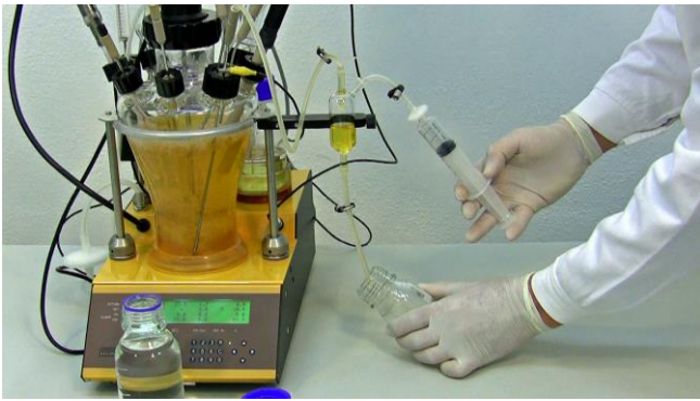
Figura 8.2—7 Utilice un recipiente para coleccionar la muestra del lavado. Presione el embolo de la jeringuilla para pasar el aire hacia el dispositivo de muestreo y por lo tanto provocar el paso del líquido de lavado desde el dispositivo de muestreo hacia la botella de desecho.
