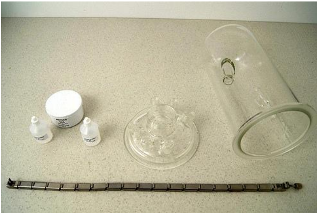
Figura 3.4-21 Preparación del vaso de reacción, ingredientes de la junta tórica líquida y el cinturón de cierre.
