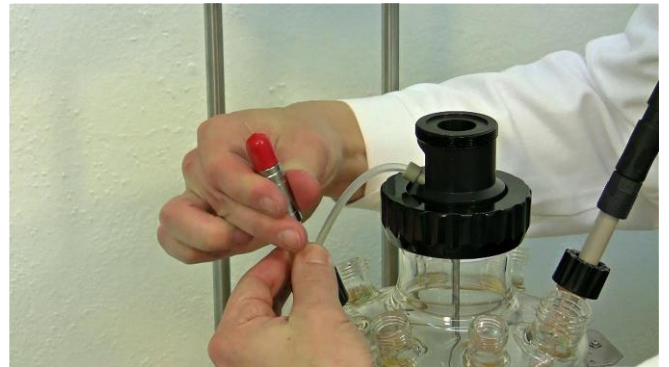
Figura 3.8-8 Asegure fuertemente la tapa negra con rosca después de la inserción o colocación del electrodo de pH.
