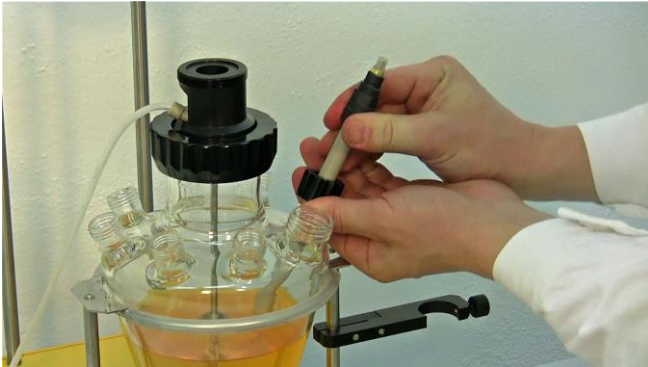
Figura 3.7-9 Inserte el electrodo a través del tapón de color fijado y de la tapa con rosca. Entonces, empuje el electrodo cuidadosamente dentro del puerto y ajuste la altura del electrodo para que quede inmerso en el medio
