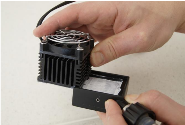
Figura 3.12-6 Separe el elemento de enfriamiento Peltier con los componentes electrónicos de control y el ventilador del dedo de condensación como se muestra durante la preparación para la esterilización.
