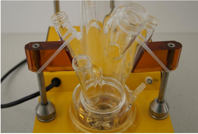
Figura 3.4-19 El vaso de reacción montado en la unidad principal de control e inmobilizado con la ayuda de los sujetadores laterales (brazos) y las juntas elásticas de silicona.
