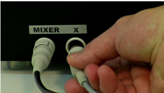
Figura 3.15-25 Conecte el cable de conexión del módulo de pesada en el enchufe o conector "X", al lado del mezclador "MIXER" ubicado en el lado izquierdo de la unidad principal de control del MINIFOR.
