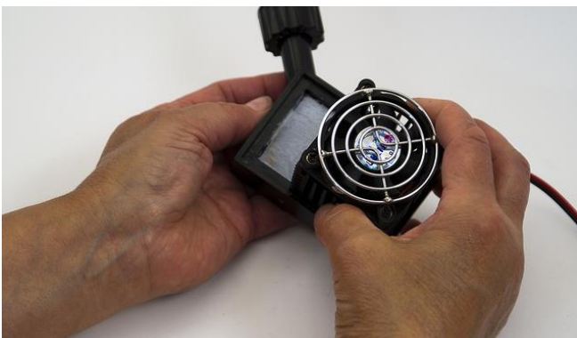
Figura 3.11-11 Una el elemento de enfriamiento Peltier con componentes electrónicos de control y el ventilador con el lazo (bucle o serpentín) de enfriamiento colocando la superficie blanca con la pasta conductora de calor sobre la trampa respectiva en la unión del dedo de enfriamiento como se muestra.
