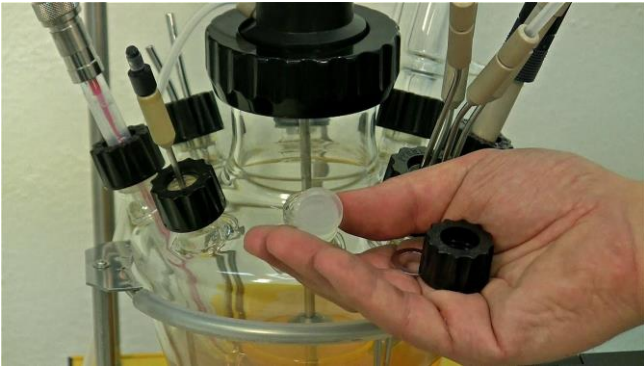
Figura 7.1—3 Coloque el tapón cerrado o de cierre con la arandela de metal y una tapa con rosca en los cuellos laterales no utilizados del vaso.
