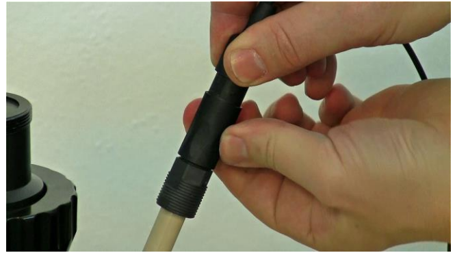
Figura 3.15-18 Después de fijar el electrodo de pO_2 (OD) y el conector exactamente en la posición de cierre, empuje hacia abajo la manga (cubierta del conector) del electrodo pO_2 (OD) y asegúrela suficientemente enroscándola.
