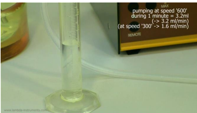
Figura 5.4-5 Mida el volumen del líquido colectado en 1 minuto.
