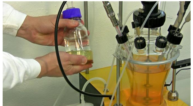
Figura 3.10-30 Las botellas de almacenamiento pueden ser convenientemente mantenidas en la parte posterior de la unidad principal de control del MINIFOR usando el sostenedor de botellas magnético.
