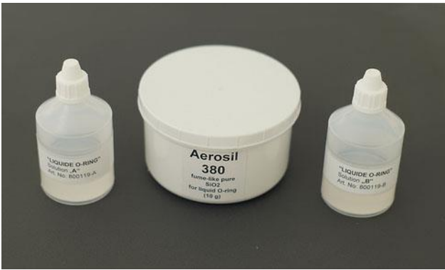
Figure 3.4-20 Ingredientes de la junta tórica líquida LAMBDA. Solución A, Solución B y AEROSIL.
