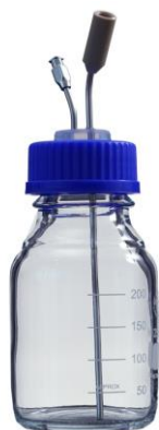
Figura 3.10-22 Botella de reactivo de 250 mL con tubo metálico (cánula con la conexión “hembra” con doble sello LAMBDA) y conexión de cierre Luer.
