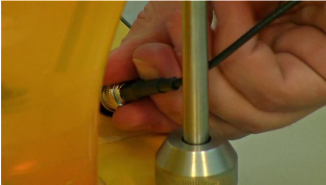
Figura 3.7-15 Asegure el conector del electrodo de pO_2 (OD) al enchufe o conector girándolo o rotándolo y presionando para cerrarlos juntos.
