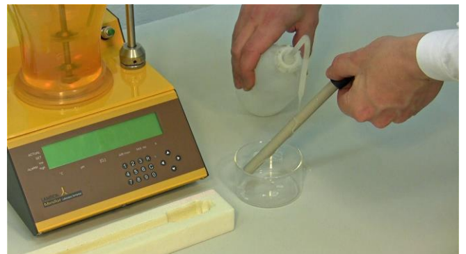
Figura 3.7-8 Humedezca el electrodo de pO 2 (OD) con agua desionizada para facilitar la inserción del electrodo.
