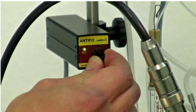
Figura 5.6-3 Ahora gire el botón en el sentido contrario a las manecillas del reloj (aproximadamente 1 mm) para fijar el punto de sensibilidad y el LED o indicador se iluminará de color verde es decir, el punto en el que el amarillo pasa a verde.
