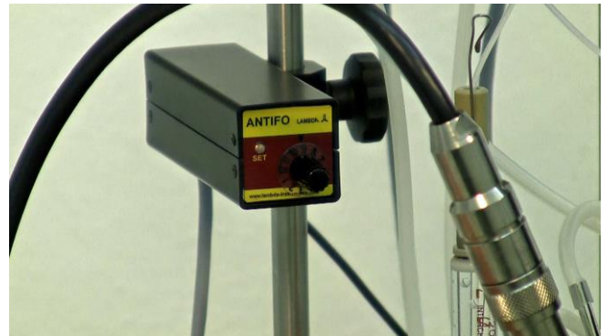
Figura 5.6-4 La sensibilidad del ANTIFO para un cultivo particular está ahora configurada. EL LED o indicador pasará de verde a amarillo, cuando este controle el DOZITO para la adición de antiespumante.
