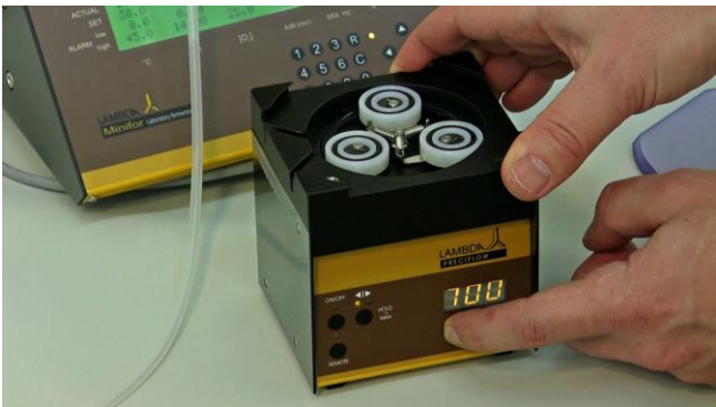
Figura 3.16-3 Ajuste la velocidad de la bomba a 700. Utilice un intervalo de velocidades de 300 a 700 para insertar o introducir la tubería o manguera.
