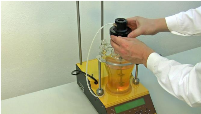
Figura 3.6-1 Tome el extremo libre de la tubería o manguera de entrada de aire (conector la tubería o manguera con doble sellado unido a la tuerca de acoplamiento móvil) a partir del la cabeza (cabezal o parte superior) de la unidad de agitación como se muestra en la figura.
