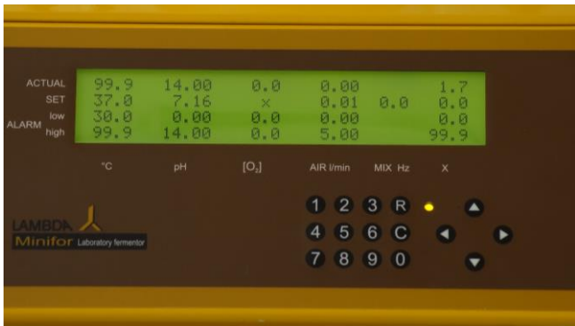
Figura 4.2-1 Modo de espera o reposo – es el estado del fermentador después de la conexión. La pantalla o monitor muestra los últimos parámetros introducidos. En esta configuración, se muestran todas las lecturas de las mediciones, pero la regulación se apaga y las teclas de números se bloquean. El LED o indicador es de color amarillo y todos los números de la pantalla o monitor están estáticos.
