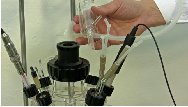
Figura 3.12-2 Condensador del gas de salida de vidrio y el filtro del gas de salida necesitan ser esterilizados junto con el vaso del MINIFOR.
