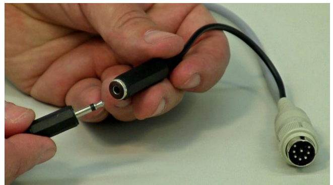
Figura 3.14-24 Conecte el cable negro del DOZITO al cable negro del ANTIFO, como se muestra.
