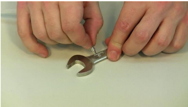
Figura 3.5-9 Tome la llave inglesa y la tubería o manguera con el inserto o pieza cónica de doble sellado. Presiónela contra la llave para introducir completamente la el inserto o pieza metálica cónica de doble sellado en la tubería o manguera.
