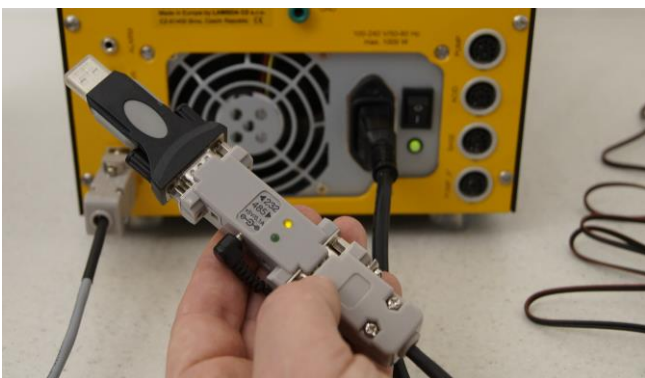
Figura 6.4—5 El LED o indicador iluminado indica que el convertidor está listo para funcionar u operar.
