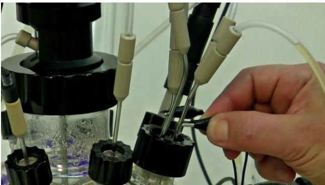
Figura 3.15-31 Ajuste la posición de la punta de la aguja "espuma" justo arriba del nivel del medio, donde la espuma debe ser controlada. Conecte la segunda pinza tipo cocodrilo a la aguja corta seleccionada.
