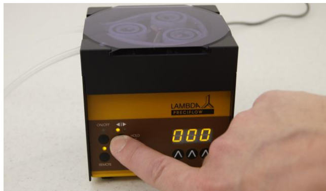
Figura 3.13-9 Presione el botón remoto en el canal "X" de la bomba peristáltica conectada.
