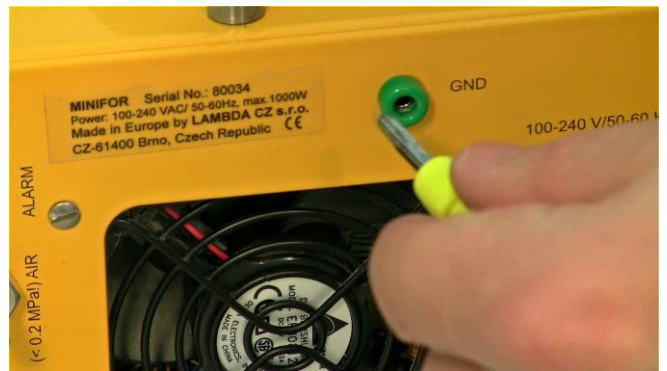
Figura 3.15-35 Conecte el cable negro con el conector verde al “GND” ubicado en la parte posterior o trasera de la unidad principal del MINIFOR para hacer la conexión a tierra.
