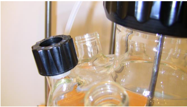
Figura 3.8-5 Coloque la tapa negra con rosca un poco suelta sobre el tapón blanco hueco y la arandela.
