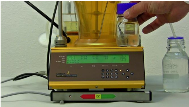
Figure 5.5-9 A continuación, coloque un peso conocido o añada un volumen conocido de líquido a la botella de vidrio. Digamos 100 g o mL.
