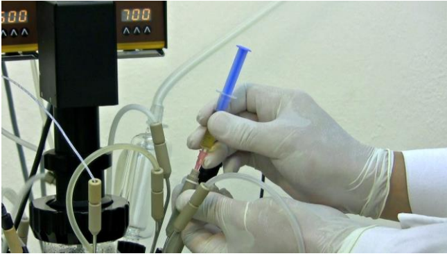
Figura 8.2—3 Inserte la jeringuilla cargada con el inóculo junto con la aguja de la jeringuilla dentro del cuerpo del adaptador del septum o tabique.
