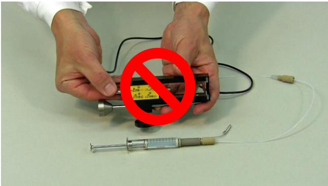
Figura 3.14-17 Tenga cuidado de no halar la varilla de acero de empuje hacia fuera de la estructura del DOZITO. Esto puede dañar la bomba del DOZITO.
