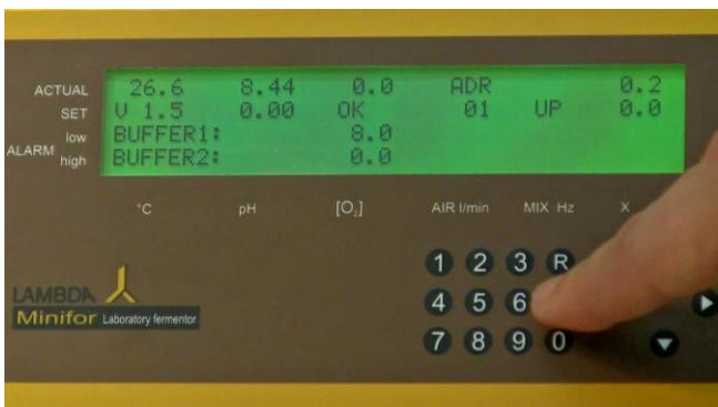
Figura 5.3-12 Presione o pulse la tecla de calibración "C". El valor calibrado se guardará o salvará y se mostrará como valor de [O 2 ] del Tampón 2. Se visualizará el mensaje de OK si la calibración se realizó correctamente.
