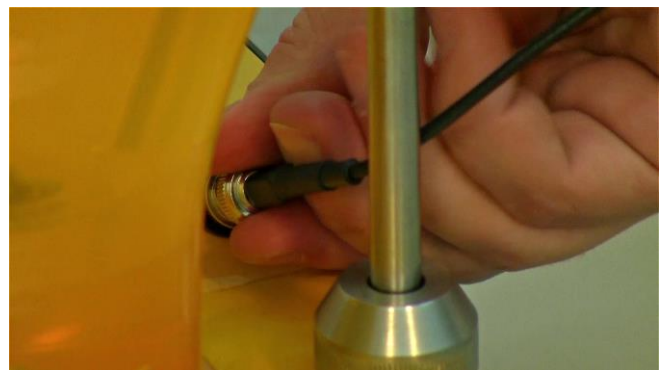
Figura 3.15-20 Asegure el conector del electrodo de pO_2 (OD) en el enchufe girándolo o rotándolo y presionando para unirlos.
