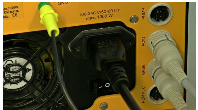
Figura 3.15-43 Conecte el cable para la fuente o suministro de energía al enchufe o conector de (100-240 V / 50-60 Hz) ubicado en la parte posterior o trasera de la unidad principal de control de la base MINIFOR.
