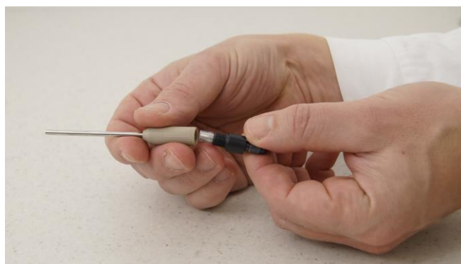
Figura 3.9-2 Inserte el otro extremo en la cánula de acero inoxidable con el conector de PEEK LAMBDA.
