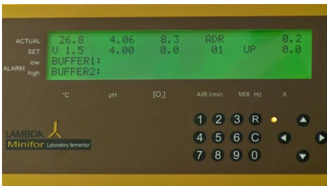
Figura 5.2-7 El pH del tampón se mostrará en el valor REAL del pH (por encima del valor preestablecido o prefijado). Espere hasta que el valor real del pH sea estable.
