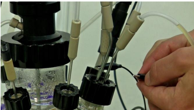
Figure 3.15-29 Conecte una de las pinzas tipo cocodrilo a la aguja para la cosecha del puerto cuádruple de muestreo.
