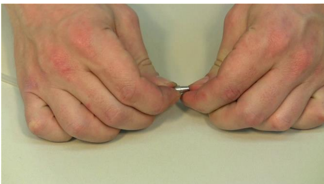
Figura 3.5-7 Inserte el inserto o pieza de metal cónica de doble sellado en la tubería o manguera que fluye libremente hacia el otro lado de la parte o pieza correspondiente de PEEK de doble sellado.
