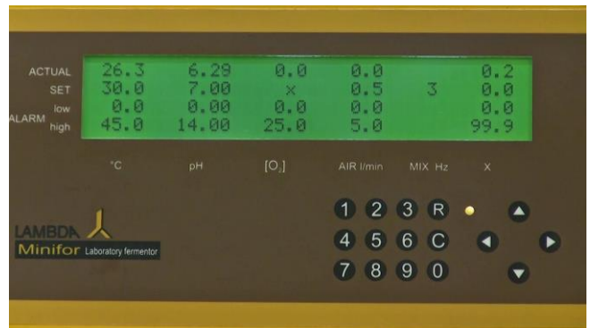
Figura 5.3-17 La lectura "REAL" después de la estabilización debe ser "0".
