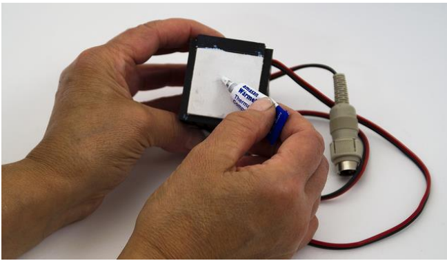
Figura 3.11-9 Aplique la pasta conductora de calor en la superficie blanca del elemento de enfriamiento Peltier con componentes electrónicos de control y el ventilador, antes de unir el dedo de enfriamiento con la unidad.
