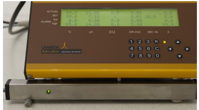
Figura 3.13-6 Si el peso del vaso es muy bajo, una señal de peso por debajo “_” aparecerá junto con el valor medido (real) de peso. [refiérase al valor real del parámetro “X” en la pantalla] y se encenderá en el módulo de pesada un LED o indicador de luz verde
