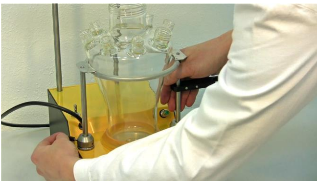
Figura 3.4-11 Mientras sostiene el sujetador del vaso de reacción con una mano, apriete uno de los orificios del sujetador del vaso de reacción con la llave para este propósito.
