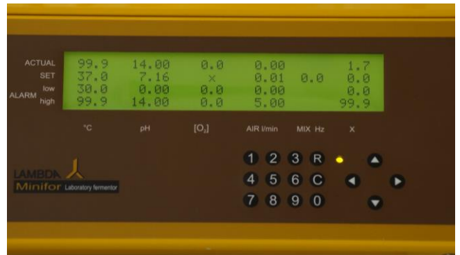
Figura 3.15-45 Cuando se enciende el MINIFOR, este empieza con un silbido y la pantalla LED o indicadora de color amarillo en el panel de control. Esto representa el modo de espera o reposo del biorreactor - fermentador MINIFOR.
