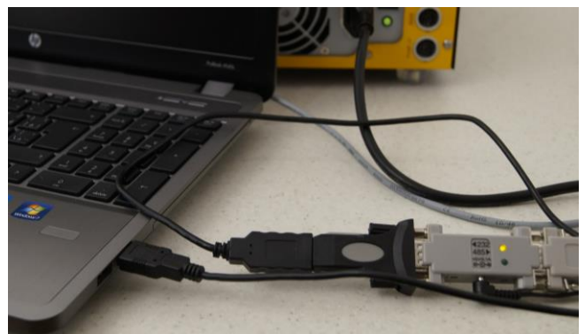
Figura 6.4—6 El cable de conexión al ordenador o computadora junto con el convertidor RS es conectado al ordenador o computadora con la ayuda del conector USB.
