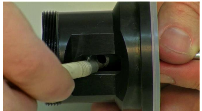
Figura 3.5-18 Inserte el conector de la tubería o manguera de doble sellado dentro de la tuerca de acoplamiento móvil a través de la cabeza (cabezal o parte superior) de la unidad de agitación. Gire el conector de la tubería o manguera de doble sellado en sentido de las manecillas del reloj o hacia derecha para apretarlo. (Atención: eje de rosca es 60° (por favor no lo fuerce))
