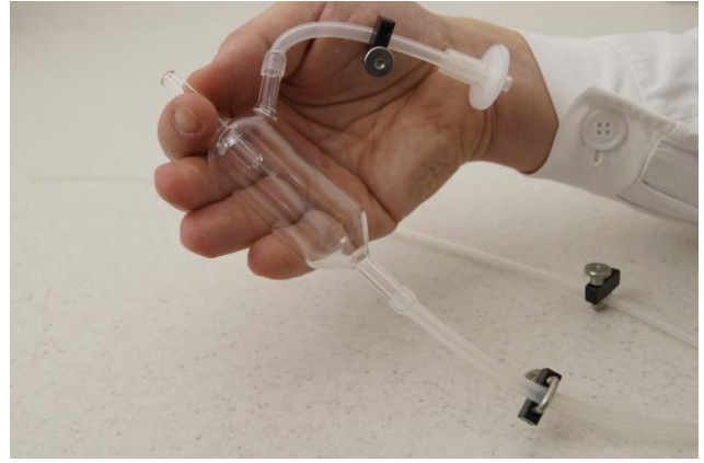
Figure 3.10-20 Un filtro esterilizable de aire (pequeño filtro de ventilación o venteo de 25 mm, tamaño de poro 0.2 \mu\text{m} ) conectado al brazo lateral por medio de una tubería o manguera corta de silicona.
