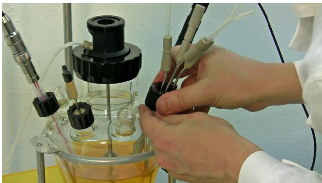
Figura 3.10-23 Inserte el puerto de muestreo cuádruple ensamblado dentro del puerto de mayor diámetro y adyacente al puerto del electrodo de pO_2 instalado. Fíjelo y asegúrelo fuertemente con la tapa negra con rosca.
