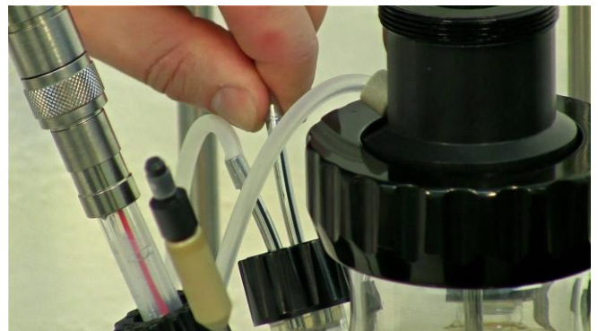
Figura 3.11-6 Deslice la tubería o manguera para la salida del líquido de enfriamiento sobre el otro tubo del lazo (bucle o serpentín) de enfriamiento para permitir el flujo de líquido de enfriamiento a través del lazo (bucle o serpentín) de enfriamiento.
