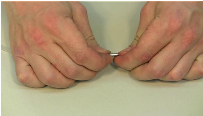
Figura 3.10-7 Inserte el inserto o pieza metálica cónica de doble sellado dentro de la tubería o manguera la cual fluye libremente hasta la otra cara de la parte de PEEK con doble sellado correspondiente.
