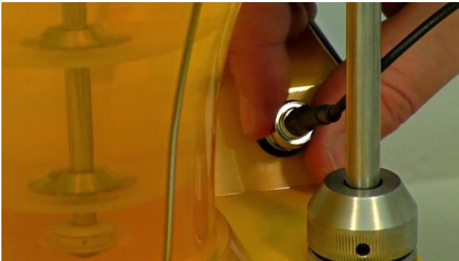
Figura 5.3-8 Para la calibración del punto cero, desconecte el electrodo de pO 2 (OD).
