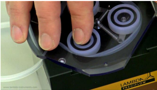
Figura 3.16-9 Asegúrese de que la bolita de acero integrada o ubicada en la esquina frontal izquierda encaje en la muesca o ranura correspondiente en la tapa o cubierta transparente de PVC.
