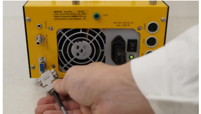
Figura 6.4—2 Conecte el cable de conexión del ordenador o computadora al conector DB 9 en la parte posterior o trasera de unidad principal de control.
