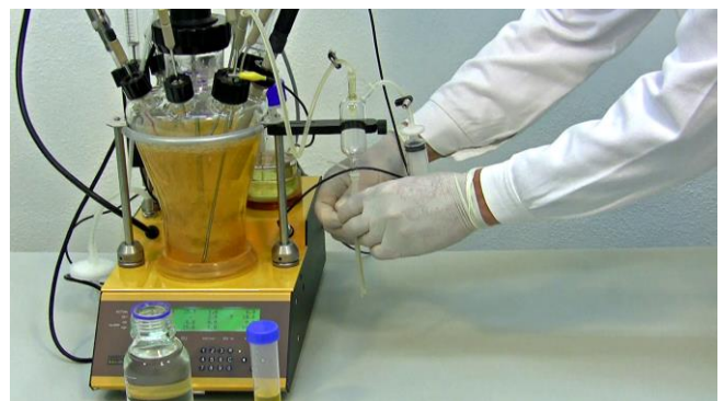
Figura 8.2—12 Cierre la pinza del tubo de salida.
