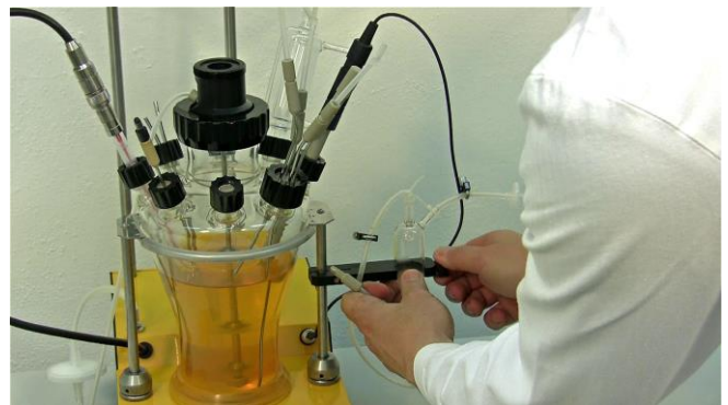
Figura 3.10-24 Coloque el dispositivo de muestreo estéril en el sostenedor del dispositivo de muestreo estéril (refiérase a 3.4 Instalación del vaso de fermentación) y ajústelo con el tornillo lateral.
