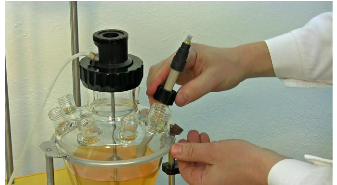
Figura 3.7-10 Asegure fuertemente la tapa negra con rosca colocada en la parte superior del tapón coloreado.
