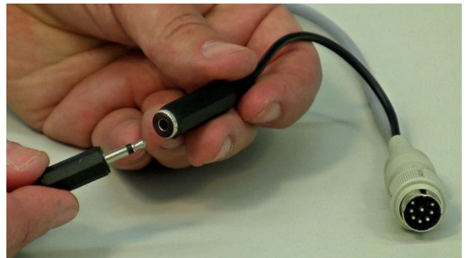
Figura 3.15-32. Conecte el cable negro del DOZITO al cable negro del ANTIFO, como se muestra.
