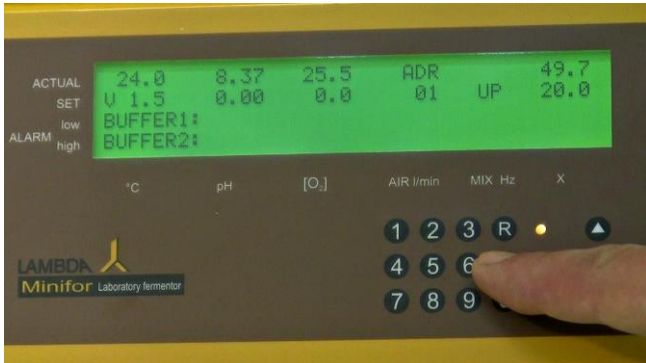
Figura 5.5-14 Para cambiar la regulación de la bomba, presione la tecla de calibración "C" para cambiar del modo de espera o reposo al modo de calibración.
