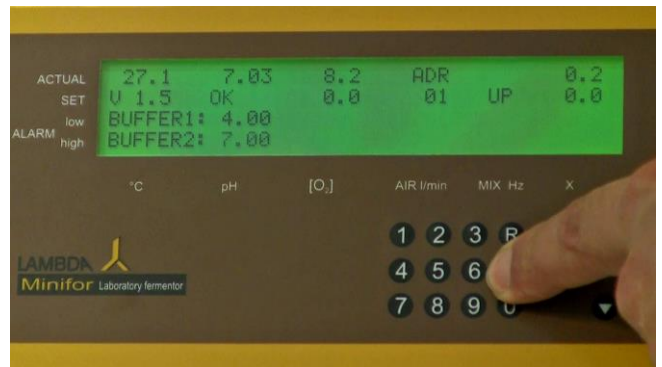
Figura 5.2-14 Cuando el valor se estabilice, presione o pulse la tecla de calibración "C". El valor calibrado se guarda o salva y se muestra como valor de pH del TAMPÓN 2.
