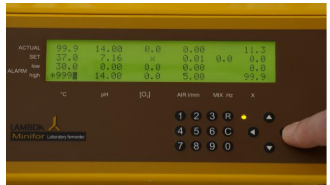
Figura 4.3-7 La alarma se puede desactivar cambiando el valor de alarma alta y tomando las precauciones necesarias para mantener la temperatura.
