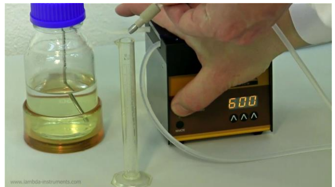
Figura 5.4-2 Encienda la bomba y tenga el otro extremo de la tubería o manguera listo o cerca de la probeta de medición. Recoja cuidadosamente el líquido que se bombea en la probeta de medición durante 60 segundos.
