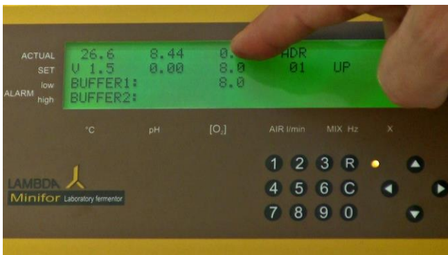
Figura 5.3-10 Cuando electrodo está desconectado, la lectura real de oxígeno disuelto debe ser siempre '0'. (Si este no es el caso, entonces el electrodo puede estar defectuoso y deberá revisar en el capítulo Polarización, cambio de la membrana de pO 2 / líquido, limpieza o contacte el servicio de ayuda de LAMBDA).
