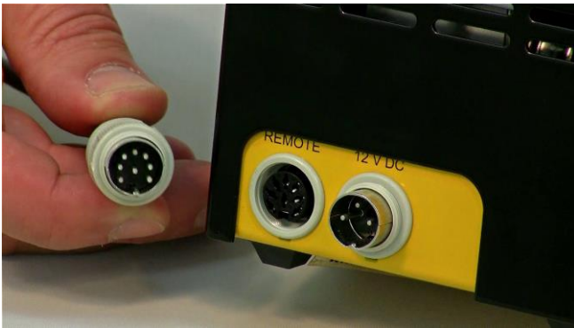
Figura 3.16-14 Conecte el cable de control remoto de la bomba de 8 polos en el enchufe o conector "Remote" ubicado en la parte posterior o trasera de la bomba peristáltica.
