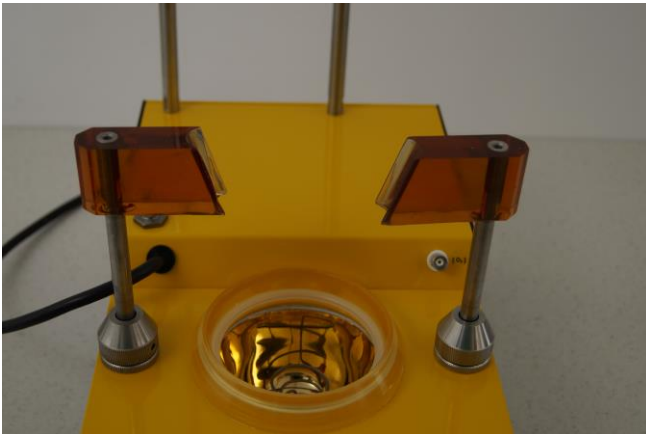
Figura 3.4-15 Inserte los sujetadores ajustables (brazos) de reacción en cada orificio de la unidad principal de control del MINIFOR y apriete las varillas a estos con la llave suministrada.
