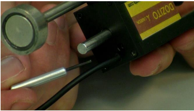
Figura 5.6-5 Utilice la llave entregada con el kit ANTIFO y DOZITO para ajustar el volumen añadido o adicionado del agente antiespumante.
