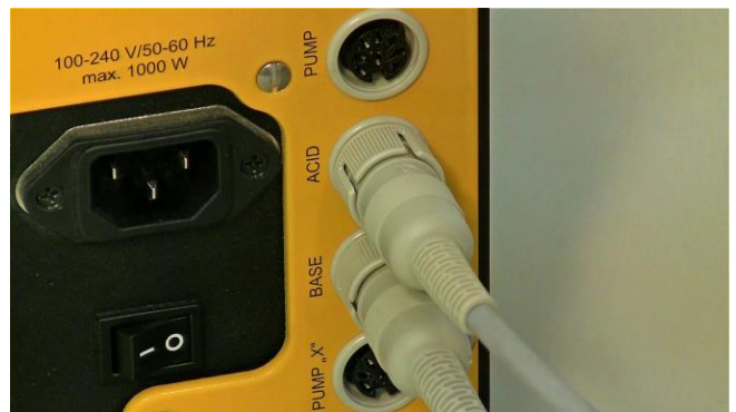
Figura 3.15-14 Conecte la bomba peristáltica que regula la adición de ácido en la reacción al enchufe o conector "ACID" ubicado en la parte posterior o trasera de la unidad principal de control del MINIFOR.
