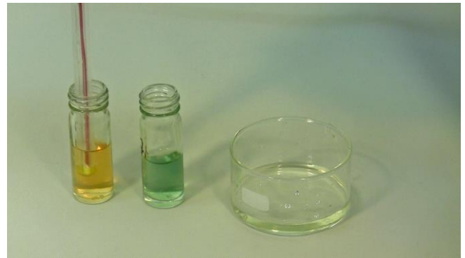
Figura 5.2-22 Compruebe la medición de pH 4 introduciendo el electrodo en la solución tampón de pH 4.
