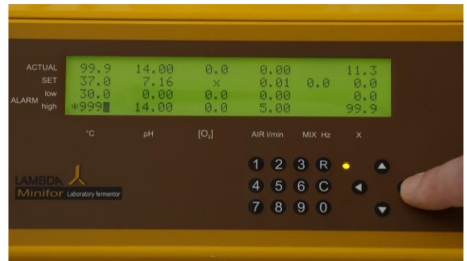
Figura 4.3-4 Mueva el cursor sobre el campo de la temperatura máxima (ALARMA ALTA). Introduzca el valor deseado. Si la temperatura es superior a este valor, se activará una alarma y el valor superado aparecerá resaltado en la pantalla.
