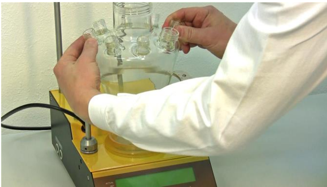
Figura 3.4-9 El puerto ubicado a continuación del puerto cuádruple es el puerto usualmente definido para el electrodo de pO_2 . El puerto que está justamente en el lado opuesto al del electrodo de pO_2 es el definido para el electrodo de pH. Estos puertos para electrodos están especialmente diseñados (colocados cerca en la circunferencia del vaso mientras que los otros puertos están de cierta forma colocados hacia adentro) para evitar la interferencia con la unidad de agitación.
