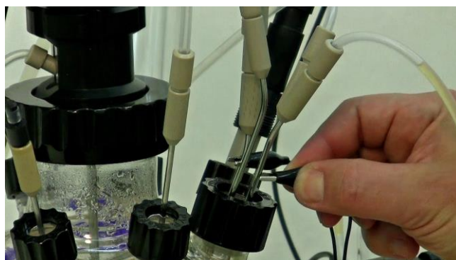
Figura 3.14-6 Ajuste la posición de la punta de la aguja "espuma" justo arriba del nivel del medio, donde la espuma debe ser controlada. Conecte la segunda pinza tipo cocodrilo a la aguja corta seleccionada.
