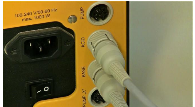
Figura 3.16-17 Conecte el cable de control remoto de la bomba peristáltica para la adición de ácido en el enchufe o conector para el ácido "ACID" ubicado en la unidad principal de control del MINIFOR.
