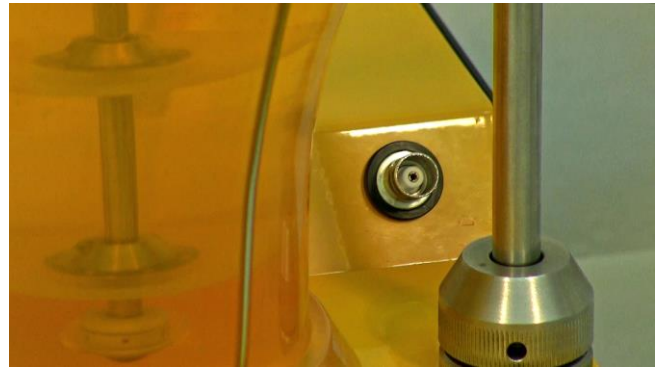
Figura 5.3-9 El electrodo de OD no deber ser retirado o desconectado por más de 1 min, ya que esto ocasionará la pérdida de la polarización. Si esto ocurriese por un tiempo mayor a 1 min, las mediciones podrán ser imprecisas.
