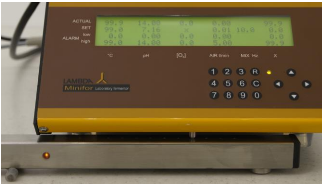
Figura 3.13-5 Si el peso del vaso lleno excede el intervalo de medición, una señal peso por encima “^” aparecerá en el valor de peso medido (real) [refiérase al valor real del parámetro “X” en la pantalla] y se encenderá en el módulo de pesada un LED o indicador de luz roja
