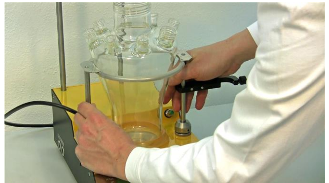
Figura 3.4-10 Ajuste el sujetador del vaso de reacción profundamente insertado alrededor del vaso de reacción, solo entonces este estará bien apoyado. Este puede estar un poco tenso o rígido, por lo que se debe ser cuidadoso.
