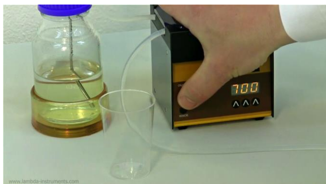
Figura 5.4-8 Encienda la bomba y tenga el otro extremo de la tubería o manguera listo o cerca del vaso de precipitado tarado previamente.
