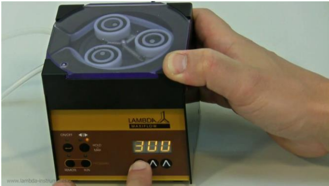
Figura 3.16-10 Los botones \wedge \wedge \wedge pueden ser utilizados para ajustar el flujo o velocidad deseado.
