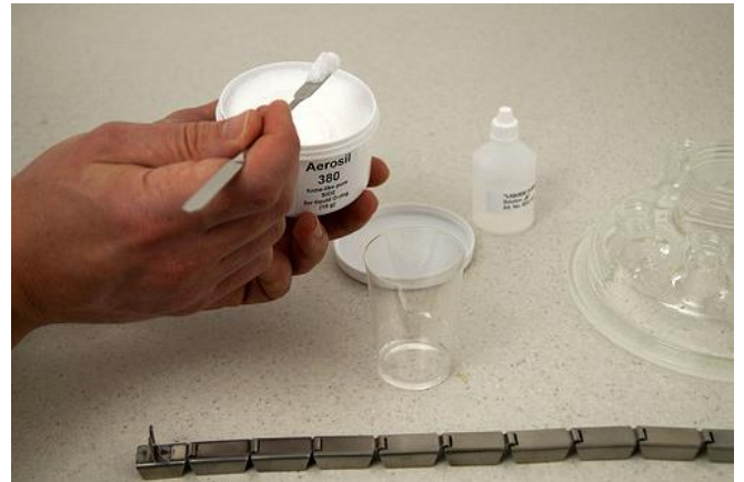
Figura 3.4-22 Tome partes iguales de las soluciones A y B en un vaso de precipitado que no sea de vidrio. Por ejemplo: 2 g de Solución "A" y 2 g de Solución "B". Adicione polvo AEROSIL hasta que la mezcla no fluya más.
