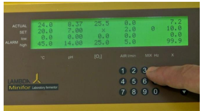
Figura 5.5-19 Presione o pulse la tecla de regulación "R" para salir del modo de calibración.
