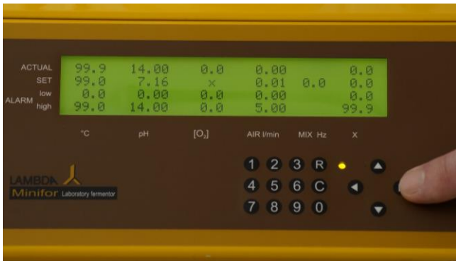
Figura 4.3-1 Mueva el cursor usando las flechas en el campo para el ajuste de temperatura (SET °C, segunda fila, primera columna).
