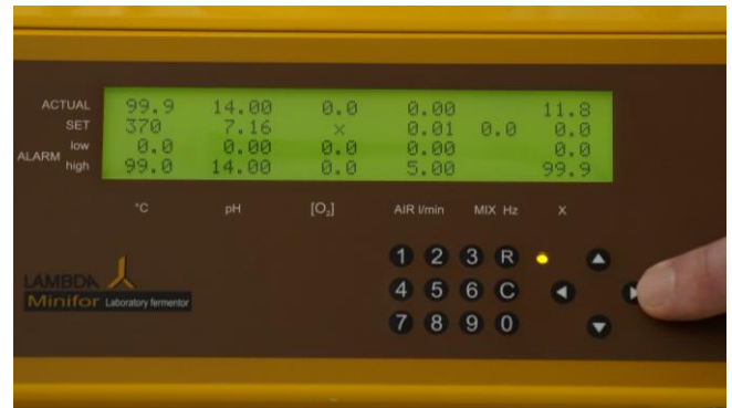
Figura 4.3-2 Introduzca el valor de temperatura deseado (el valor que se muestra en la primera línea y la primera columna corresponde a la temperatura medida y no puede ser cambiado).
