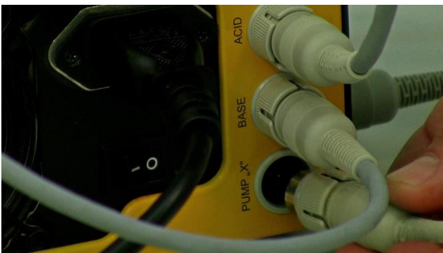
Figura 3.16-18 La bomba de suministro de medio o de cosecha de sobrenadante del módulo de pesada debe ser conectada al enchufe o conector de la bomba X "PUMP X".
