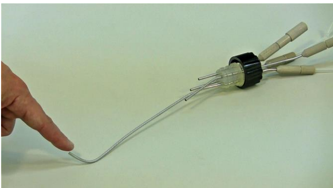
Figura 3.15-36 El cable para hacer la conexión a tierra tiene que ser conectado en la cánula más larga en el puerto de muestra cuádruple.
