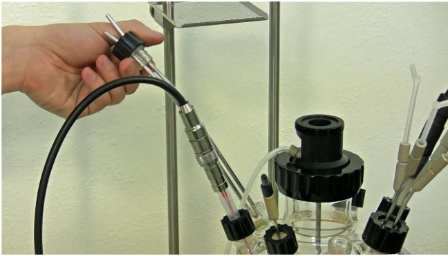
Figura 3.11-3 Coloque el lazo (bucle o serpentín) de enfriamiento en el cuello seleccionado en la parte posterior o trasera del vaso para dejarlo imperturbable.
