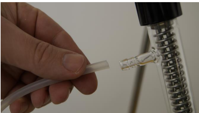
Figura 3.12-14 Conecte una tubería o manguera al cilindro condensador del gas de salida y lleve la tubería o manguera a un vaso o frasco de vidrio.
