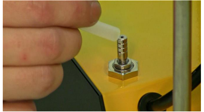
Figura 3.6-6 Con el otro extremo de la tubería o manguera del filtro de aire de entrada, conéctelo a la salida de aire de la unidad principal de control como se muestra. Inserte la tubería o manguera profundamente hasta el fondo de la toma de salida de aire.
