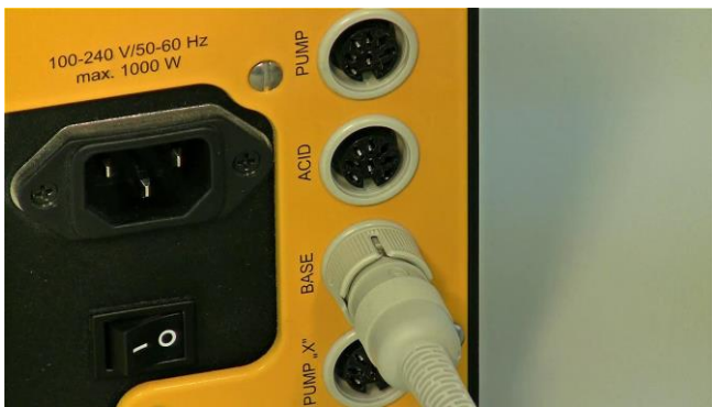
Figura 3.15-13 Para el control automático del pH, conecte la bomba / Massflow que controla la adición de base a la reacción al enchufe o conector ubicado en la parte posterior o trasera de la unidad de control del MINIFOR.
