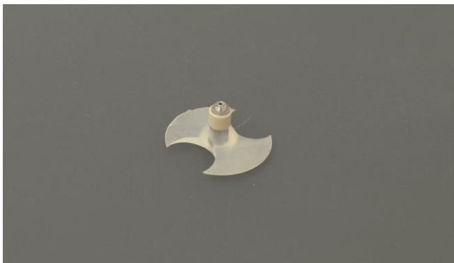
Figura 3.5-27 Disco agitador con forma de mariposa para vasos de 0,3 L.
