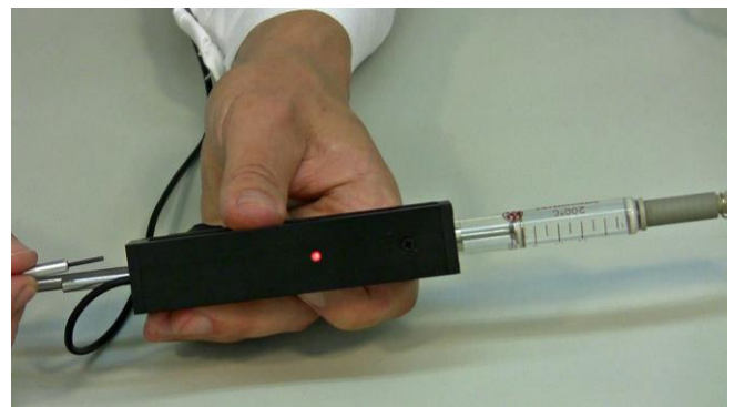
Figura 5.6-10 Cuando la dosis preestablecida o prefijada ha sido entregada, el LED o indicador cambiará a rojo. Entonces la comunicación con el ANTIFO se interrumpe durante 20 segundos y el LED o indicador se apaga.
