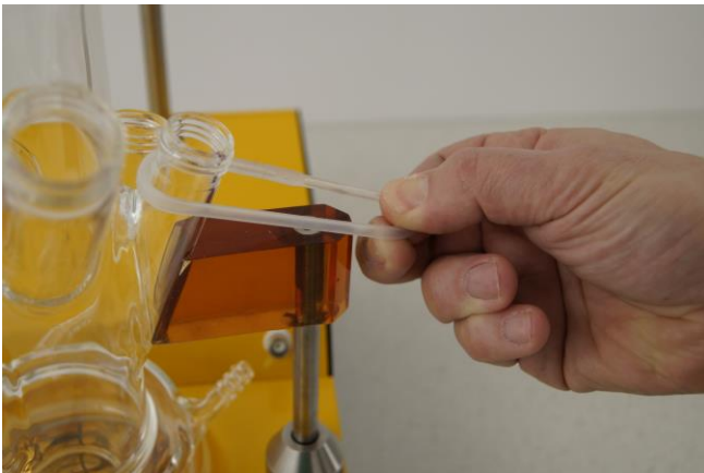
Figura 3.4-17 Coloque la junta elástica de silicona en los brazos o puertos laterales para los electrodos de pH y pO_2 .
