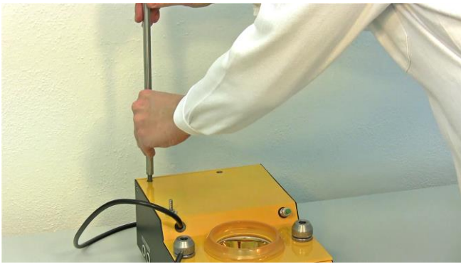
Figura 3.3-1 Como primer paso, inserte las varillas de soporte en la unidad principal de control como se muestra en la figura. Gírelas o rótelas en el sentido de las manecillas del reloj o hacia la derecha para fijarlas.
