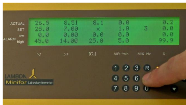
Figura 4.1-2 Pulse o presione la tecla "C" para pasar del modo de espera o reposo al modo de calibración.
