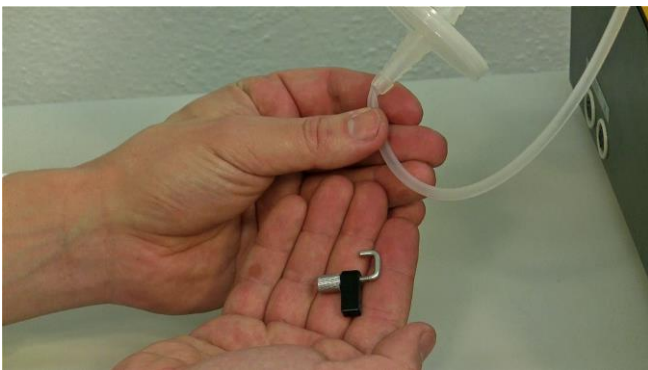
Figura 3.6-7 El cierre de seguridad es suministrado para la entrada de aire. Este protege el filtro de aire de entrada para el caso de líquidos que puedan entrar desde la línea de salida / entrada de aire.
