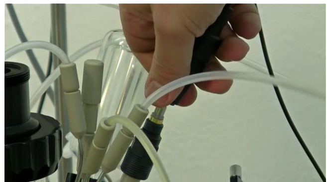
Figura 7.1—6 Desconecte el cable conector del electrodo de pO 2 del electrodo de pO 2 .
