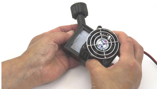
Figura 3.11-7 Separe la unidad del motor y ventilador de las tuberías de enfriamiento como se muestra durante la preparación para la esterilización.
