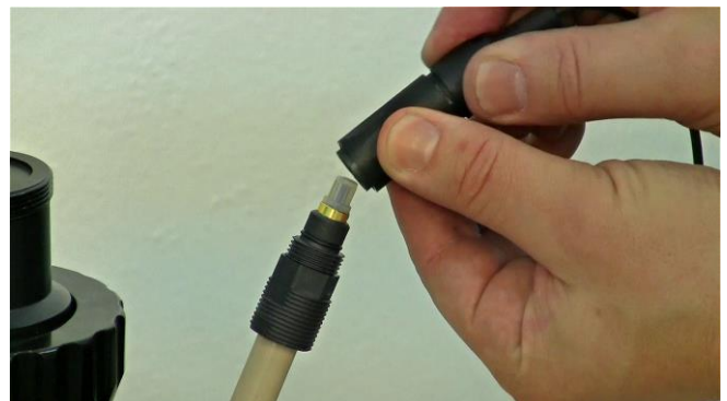
Figura 3.15-16 Ajuste la manga (cubierta del conector) del electrodo de pO_2 (OD) empujándolo hacia arriba como se muestra.
