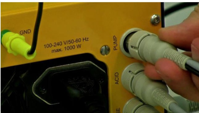
Figura 3.14-25 Conecte el cable del ANTIFO (8 polos) al enchufe o conector de la "bomba" ubicado en la parte posterior o trasera de la unidad principal de control del MINIFOR.
