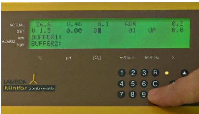
Figura 5.3-5 Introduzca el valor de la Tabla en el valor preestablecido o prefijado para [O 2 ] y luego presione la tecla de la flecha derecha (>) (ej., 80)
