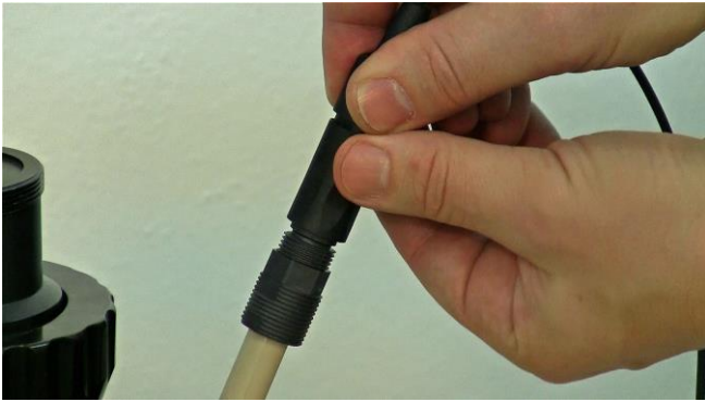
Figura 3.15-17 Coloque y ajuste el conector del electrodo de pO_2 (OD) girándolo o rotándolo para encontrar la posición para el cierre exacto o justo con el electrodo de pO_2 (OD).
