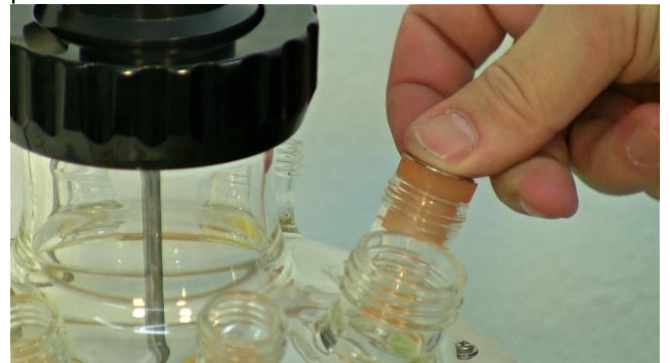
Figura 3.7-6 Asegúrese de que la arandela este colocada sobre el tapón de goma.
