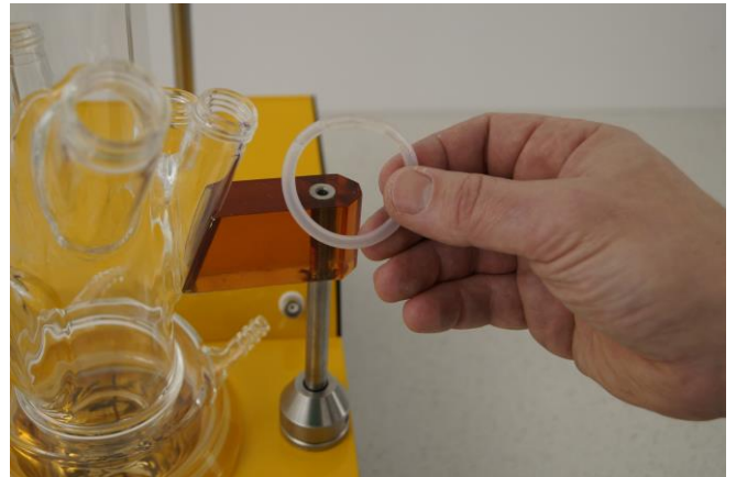
Figura 3.4-16 Coloque el vaso de reacción en la unidad principal de control con lo cual, los brazos laterales distintivos para los electrodos de pH y pO_2 son apoyados por sujetadores laterales del vaso de reacción. Las juntas elásticas de silicona ayudan a fijar el vaso al sujetador del vaso reacción.
