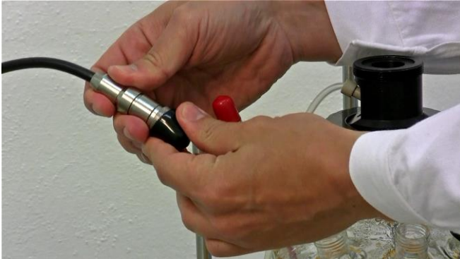
Figura 3.15-5 Coja o tome el conector del electrodo de pH de la unidad principal del biorreactor MINIFOR. (Cable negro de la unidad). Retire la tapa protectora negra del sensor (parte superior) del cable.
