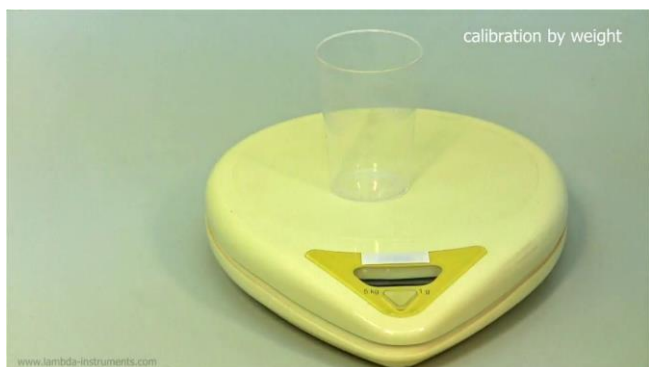
Figura 5.4-6 Pese un vaso de precipitado vacío usando una escala de pesada sensible. Para la medición exacta del líquido colectado, tare la escala de pesada con el vaso de precipitado (por ejemplo: 0.000 g).
