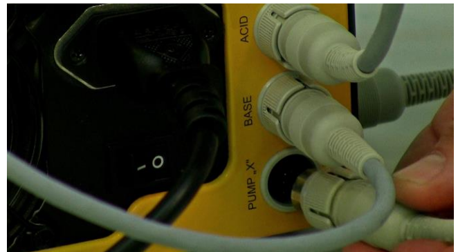
Figura 3.15-26 Conecte la bomba correspondiente (para la adición o eliminación de medio) al enchufe o conector de la bomba "PUMP X" ubicado en la parte posterior o trasera del biorreactor MINIFOR.
