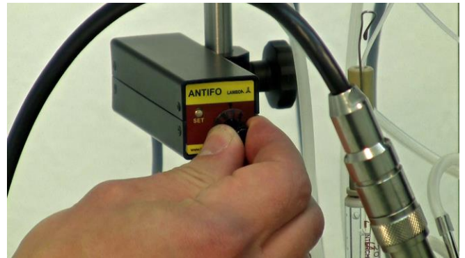
Figura 5.6-2 Gire o rote gentilmente el botón del ANTIFO en el sentido de las manecillas del reloj para encontrar un punto en el que el LED o indicador verde se ponga en amarillo como se muestra.
