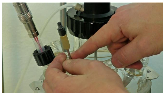
Figura 3.9-4 Inserte el tapón con la válvula de seguridad limitante de sobrepresión ensamblada dentro del puerto. (Probablemente la válvula de seguridad limitante de sobrepresión puede ser colocada al lado del puerto del electrodo de pH).
