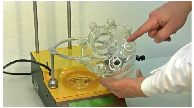
Figura 3.4-8 El puerto que se señala en la foto (más grande, ej., puerto de mayor diámetro) es el puerto cuádruple para el muestreo estéril y también para la adición de ácidos o bases.
