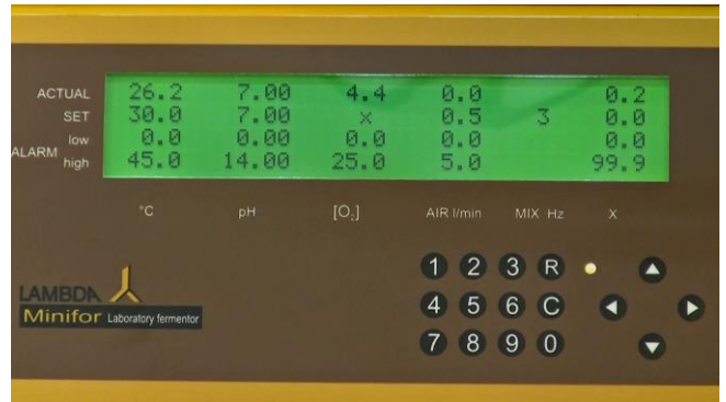
Figura 5.2-20 El valor REAL de pH del parámetro deberá ser 7,00 (Puede variar entre 6,95 a 7,04).
