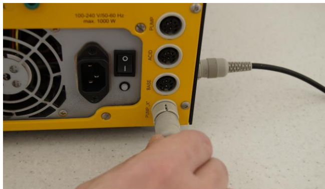
Figura 3.13-8 Conecte la bomba correspondiente al enchufe o conector de la bomba X o "PUMP X"*) en la parte posterior o trasera del biorreactor - fermentador MINIFOR.
