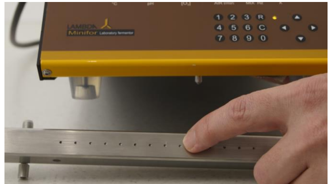
Figura 3.13-2 La punta de acero (módulo de escala pequeña) bajo la parte frontal de la unidad del MINIFOR debe ser colocada en estas ranuras o cavidades del módulo de pesada.
