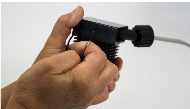
Figura 3.11-13 La pinza de cierre tiene que ser alada firmemente a través del elemento de enfriamiento Peltier con componentes electrónicos de control y el ventilador para hacer el dedo de enfriamiento Peltier intacto o inmóvil.
