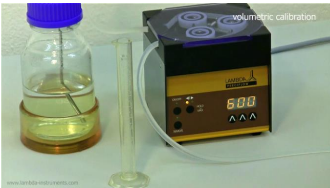
Figura 5.4-1 Conecte la tubería o manguera al líquido en la botella y ajuste la velocidad deseada (por ejemplo, 600). Mantenga la probeta de medición lista.
