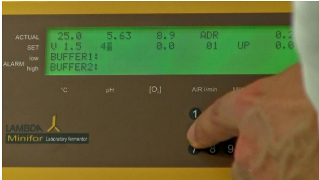
Figura 4.1-7 La tecla de números se utiliza para cambiar el valor del cursor parpadeante.
