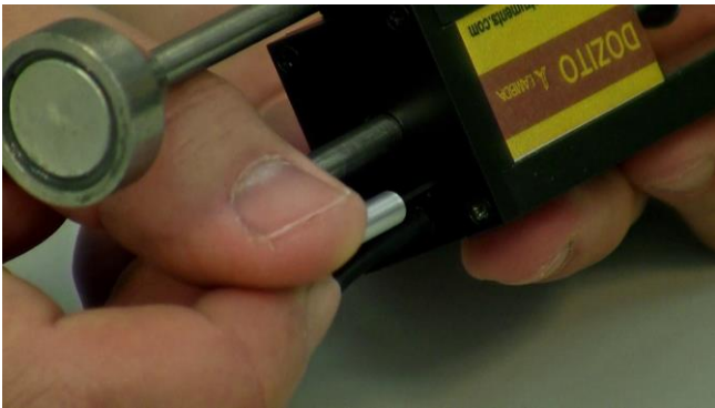
Figura 5.6-7 Enroscado = rotación a favor de las manecillas del reloj = decremento o disminución del volumen del antiespumante / intervalo.
