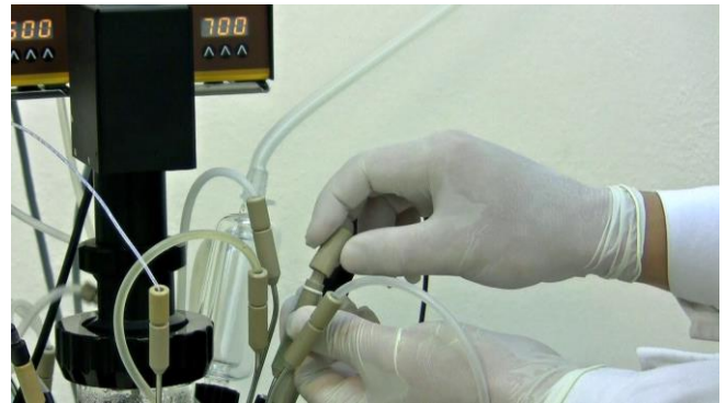
Figura 8.2—6 Coloque nuevamente la tapa de protección del septum o tabique en forma segura.
