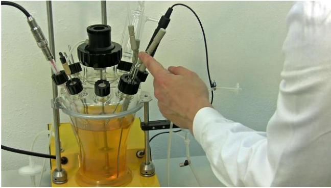
Figura 3.10-25 Retire el cierre de protección de la tubería o manguera con doble sello sobre la cánula más larga del puerto de muestreo cuádruple como se muestra.
