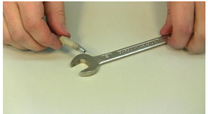
Figura 3.5-10 La foto muestra el conector de la tubería o manguera de PEEK de doble sellado preparado.
