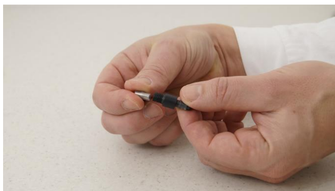
Figura 3.9-1 Inserte un extremo del inserto o pieza metálica cónica doble a la válvula de seguridad de sobrepresión.
