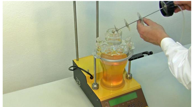
Figura 3.5-26 Asegúrese que la tapa grande central con rosca para fijar en la cabeza esté apretada de manera segura al borde del vaso de reacción. Vea que la tubería sostenida por la tuerca de acoplamiento móvil de PEEK para la entrada de aire esté colocada como en la figura.
