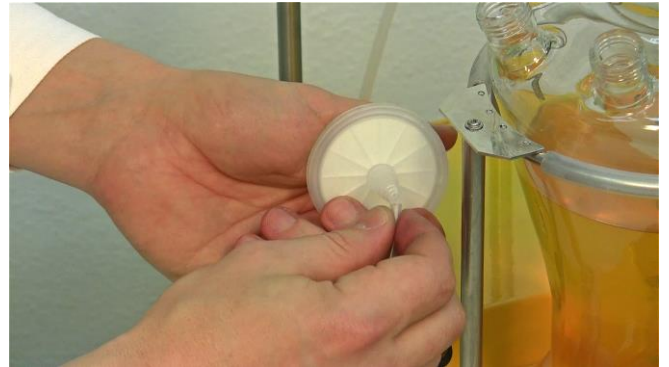
Figura 3.6-2 Conecte la tubería o manguera de entrada de aire de la unidad de agitación a un extremo del filtro de aire de entrada.
