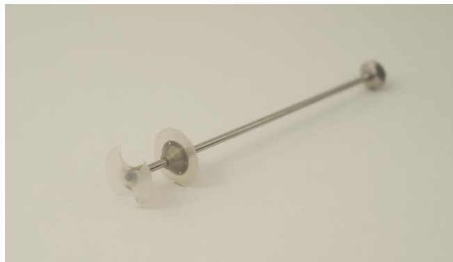
Figura 3.5-28 Disco agitador con forma de mariposa montado en el tubo del distribuidor de burbujas en lugar del microdistribuidor de burbujas con auto-limpieza para vasos de 0,3 L.
