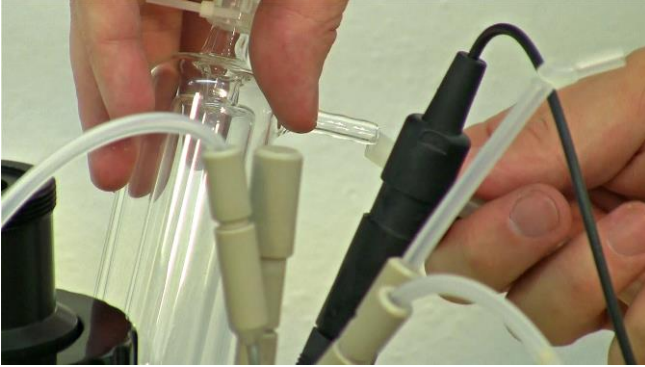
Figura 3.12-5 Conecte el agua de enfriamiento al condensador del gas de salida (brazo inferior = entrada, brazo superior = salida para el agua de enfriamiento).
