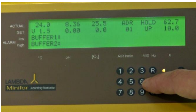
Figura 5.5-7 Observe el valor real del peso medido. Cuando la lectura sea estable, espere hasta que aparezca el mensaje "HOLD". A continuación, presione o pulse la tecla de calibración "C" para calibrar el valor inicial.
