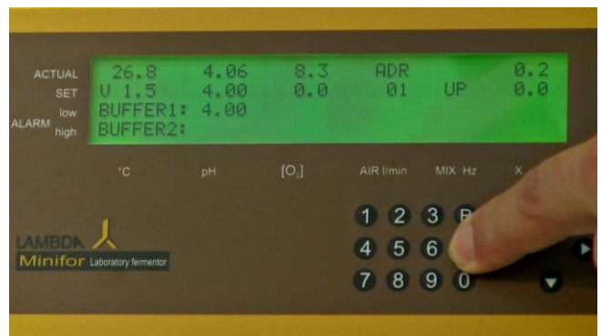
Figura 5.2-8 Cuando el valor real del pH sea estable, presione la tecla de calibración "C" con el fin de guardar o salvar la calibración. El valor calibrado se mostrará como valor de pH del TAMPÓN 1.
