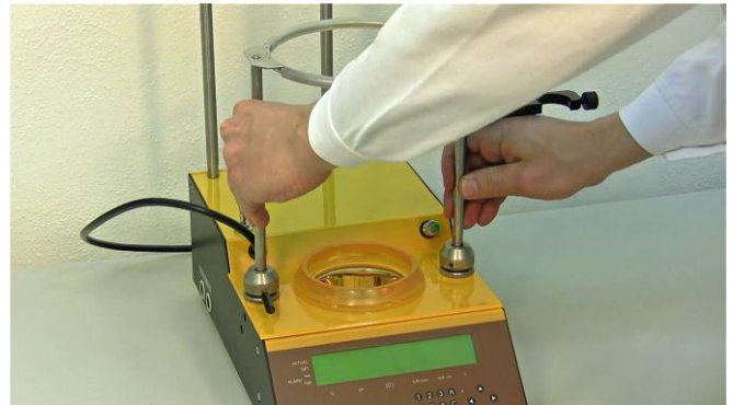
Figura 3.4-6 El sujetador vaso de reacción con el sujetador del dispositivo de muestreo estéril necesita ser fijados en la unidad principal de control MINIFOR. Coloque el sujetador del vaso de reacción en los 2 orificios disponibles para este propósito a cada lado del bloque de calentamiento que simula el calentamiento solar.
