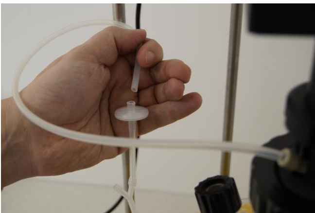
Figura 3.6-11 Conecte la tubería o manguera con el filtro desde el conector o pieza en forma de Y hasta el distribuidor de burbujas.
