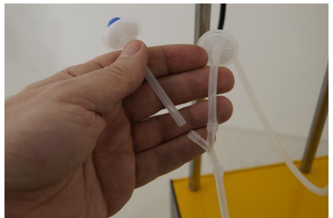
Figura 3.6-12 Inserte otra tubería o manguera con el filtro hasta el conector o pieza en forma de Y para la distribución de burbujas en la superficie.
