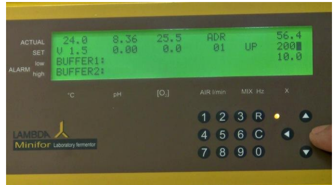
Figure 5.5-10 Introduzca el valor final a ser detectado y controlado por el módulo de escala. Por ejemplo: introduzca 200 y presione la tecla de flecha derecha (>) para guardar o salvar el valor.
