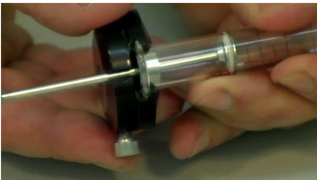
Figura 3.14-14 Gire o rote el soporte, en aras de fijar la jeringuilla en la posición de forma segura.
