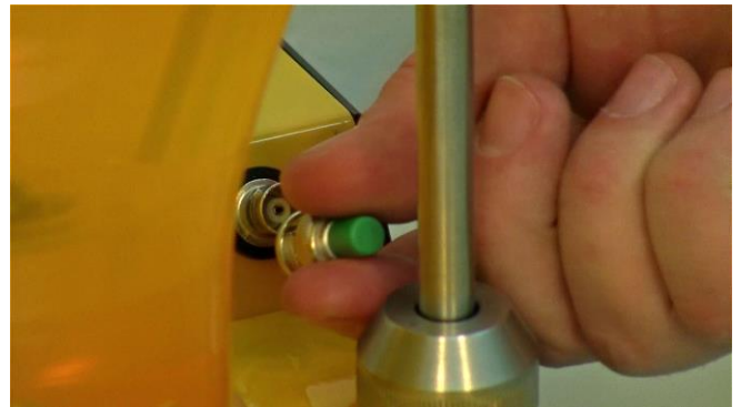
Figura 3.7-14 Retire la tapa de seguridad presionando y aflojándola mediante el giro o la rotación del enchufe o conector del electrodo de pO_2 (OD) en la unidad principal de control.
