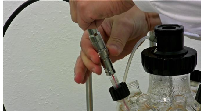
Figura 3.8-12 Después del cierre de las ranuras del electrodo de pH y del cable conector, apriete la conexión enroscando la cerradura con rosca en el cable conector rotándola como se muestra.
