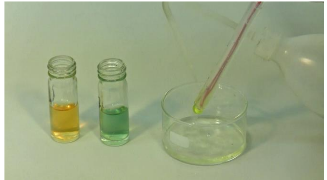
Figura 5.2-18 Enjuague el electrodo con agua desionizada y séquelo con papel secante.
