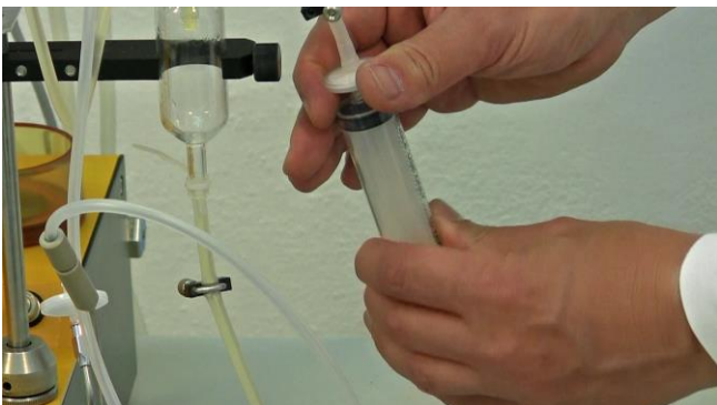
Figura 7.1—11 Retire la jeringuilla del dispositivo de muestreo estéril. Cierre todas las pinzas de las tuberías o mangueras. Si el dispositivo de muestreo es empleado, entonces retírelo y desconéctelo de la cánula y la jeringuilla.
