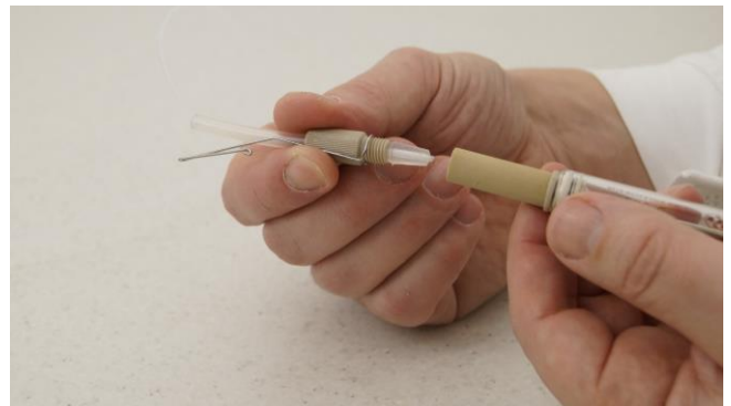
Figura 3.14-10 . Inserte la parte de PEEK con doble sello que se ajusta preparada con el inserto o pieza de silicona cónica y la tubería o manguera de PTFE al adaptador de PEEK conectado con la jeringuilla
