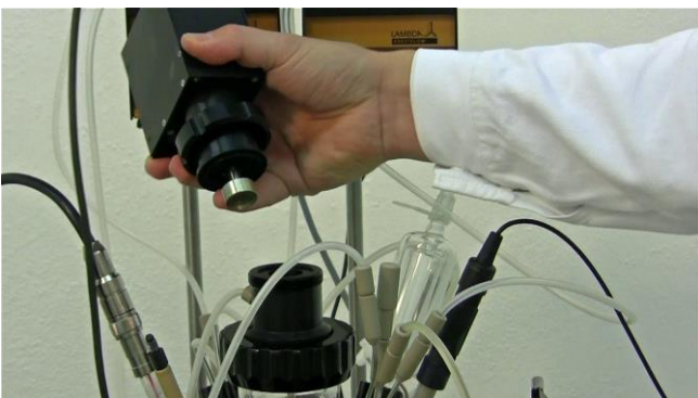
Figura 7.1—5 Retire el agitador de la unidad de agitación. Incline con cuidado el agitador de un lado al otro para sacarlo con mayor facilidad.
