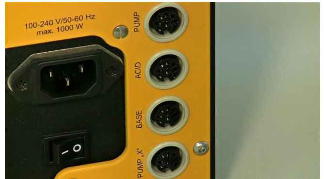
Figura 3.16-15 Las bombas tienen que ser conectadas en los respectivos enchufes o conectores ubicados en la parte posterior o trasera o de la unidad principal de control del MINIFOR.
