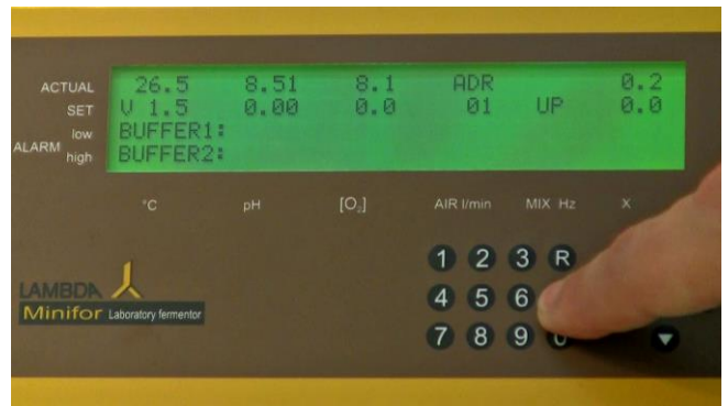
Figura 5.5-2 Una pulsación duradera de la tecla de calibración "C" activará los valores preestablecidos o prefijados en la pantalla o monitor.
