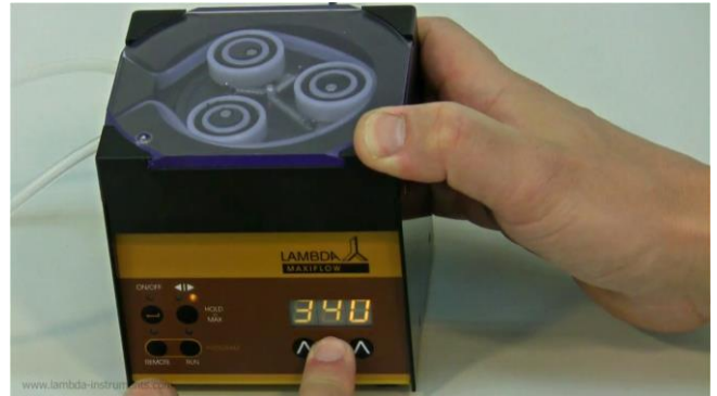
Figura 3.16-11 Cada flecha \wedge \wedge \wedge puede ser utilizada para cambiar el dígito correspondiente sobre el flujo o velocidad.
