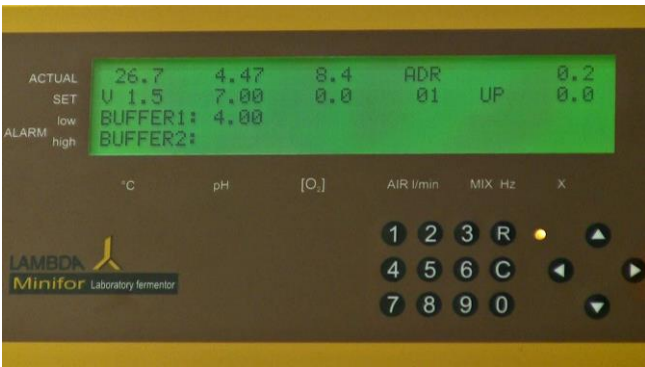
Figura 5.2-11 Después de presionar o pulsar la tecla de la flecha derecha ">", el valor introducido (700) se establecerá como pH 7,00.
