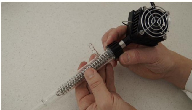
Figura 3.12-12 Inserte el cilindro condensador del gas de salida con la conexión de la tubería o manguera sobre el dedo de condensación y apriételo o asegúrelo con la tapa negra con rosca.
