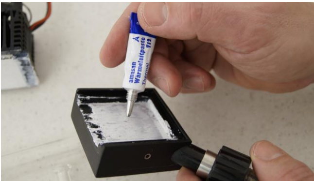
Figura 3.12-8 Aplique la pasta conductora de calor en la superficie blanca del elemento de enfriamiento Peltier con los componentes electrónicos de control y el ventilador, antes de unir el dedo de condensación con la unidad. Esparza delicadamente la pasta conductora de calor en la superficie regular asegurándose de que no existan burbujas de aire atrapadas.
