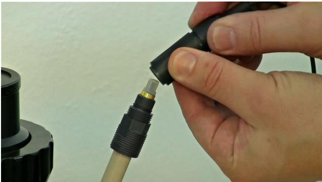
Figura 3.7-11 El conector del electrodo de pO_2 (OD) tiene que estar conectado entre el electrodo de pO_2 y el enchufe o conexión del electrodo de pO_2 (OD) en la unidad principal de control. Ajuste la cubierta del conector del electrodo de pO_2 (OD) empujándolo hacia arriba como se muestra.
