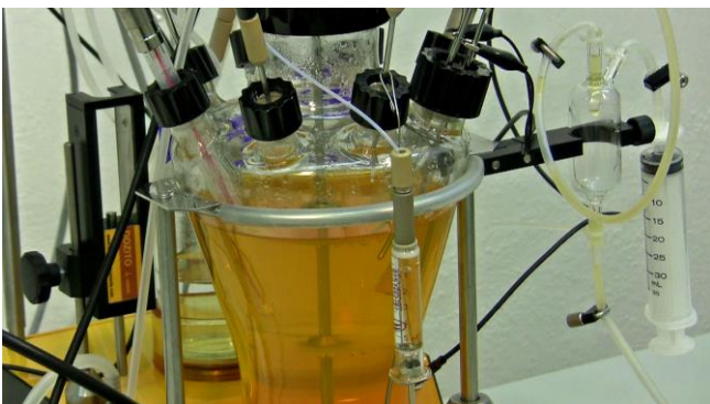
Figura 3.14-16 Acople la jeringuilla, con la ayuda del soporte montado en la pieza o cabezal de PEEK, en una de las agujas / cánulas insertadas en el puerto.
