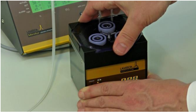
Figura 3.16-1 Para la instalación de las tuberías o mangueras en la bomba peristáltica, gire o rote la cubierta de PVC transparente, ya sea en la dirección o en contra de las manecillas del reloj, o sea hacia la derecha o hacia la izquierda para quitarla.
