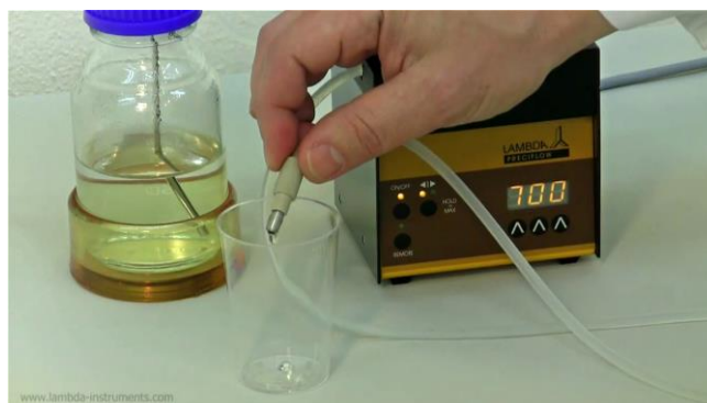
Figura 5.4-9 Colecte cuidadosamente el líquido bombeado en el vaso de precipitado por aproximadamente 60 segundos.
