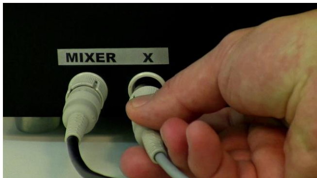
Figura 3.13-3 Conecte el cable de conexión del módulo de pesada en el enchufe o conector "X" justo al lado del "MIXER o MEZCLADOR" en el lado izquierdo de la unidad principal de control del MINIFOR.
