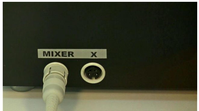
Figura 3.15-4 Conecte el cable de la unidad de agitación al enchufe o conector para el mezclador "MIXER" ubicado en el lado izquierdo de la unidad principal del MINIFOR.
