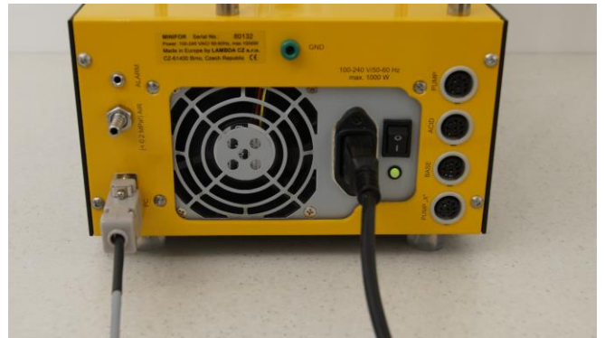
Figura 3.15-41 El extremo del cable conector de la alarma tiene que estar conectado dentro del enchufe de la alarma en la parte trasera de la unidad principal de control. El otro extremo del cable puede ser conectado a los dispositivos deseados.
