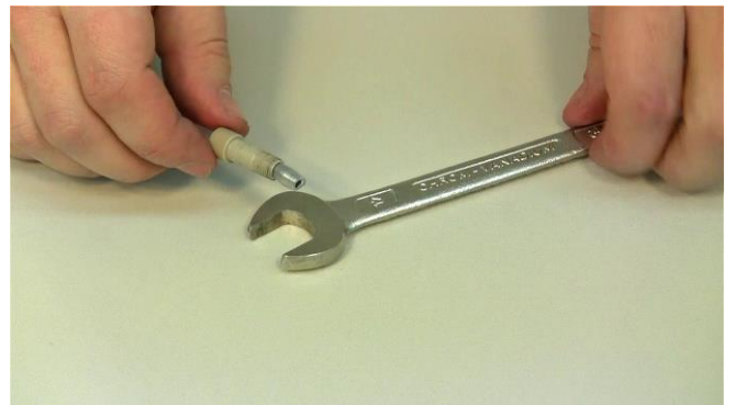
Figura 3.10-10 La figura muestra el conector de la tubería o manguera de PEEK de doble sellado preparado.
