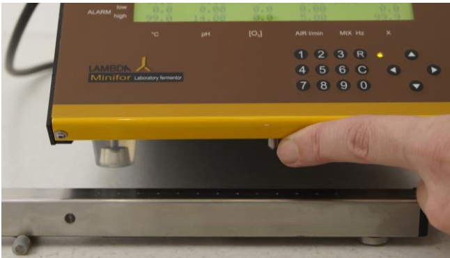
Figura 3.13-1 La punta de acero se puede encontrar bajo la parte frontal de la unidad del MINIFOR (módulo de escala pequeña). Coloca el módulo de pesada bajo la parte frontal del MINIFOR.
