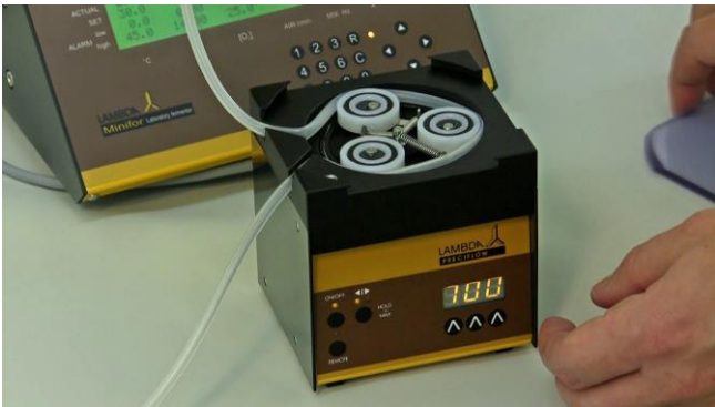
Figura 3.16-7 Presione la tubería o manguera en la ranura o muesca frontal para asegurarla.
