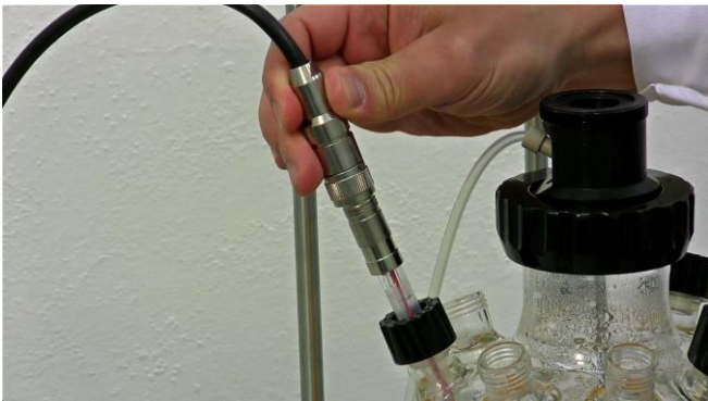
Figura 3.15-7 Conecte el cable del conector del electrodo de pH de la unidad principal del MINIFOR con el electrodo de pH. Gire o rote o y ajuste el cable del conector para lograr un cierre exacto o completo .
