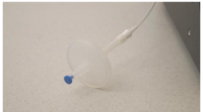
Figura 3.6-4 La foto muestra la conexión del filtro de aire de entrada con la tubería o manguera de la cabeza (cabezal o parte superior) de la unidad de agitación usando el conector de las tuberías o mangueras.
