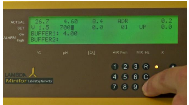
Figura 5.2-10 Inicie o comience la calibración de la segunda solución de calibración, introduciendo el siguiente valor de pH y entonces presione la tecla de la flecha derecha ">" para ajustar el valor de pH necesario.
