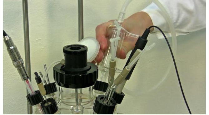
Figura 3.12-3 Inserte el condensador del gas de salida dentro del puerto con el tapón abierto o hueco, una arandela y la tapa negra con rosca. Seleccione un puerto que no sea perturbado durante el trabajo.
