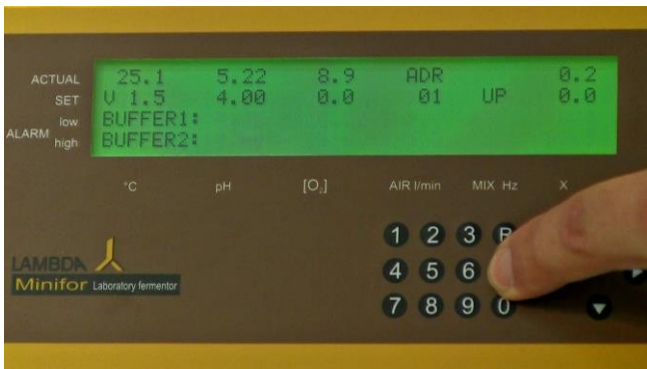
Figura 5.2-3 La presión continua sobre la tecla "C" activa el cursor del valor de pH preestablecido o prefijado.
