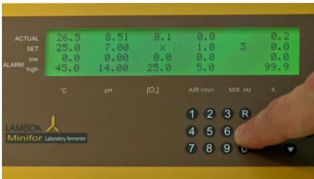
Figura 5.5-1 Cuando el vaso esté bien posicionado en el módulo de escala, presione la tecla de calibración "C" para cambiar del modo de espera o reposo al modo de calibración.
