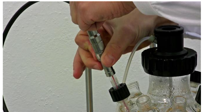
Figura 3.15-8 Después de cerrar o unir el electrodo de pH y cable conector; apriete la conexión enroscando el cierre con rosca en el cable conector como se muestra.
