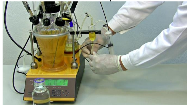
Figura 8.2—10 Hale el émbolo de la jeringuilla para llenar el dispositivo de muestreo de vidrio con la muestra proveniente del vaso de reacción. Nunca llene el dispositivo de vidrio completamente. Muestree dos veces si se requiere gran cantidad o volumen de muestra. Cierre la pinza de la entrada el puerto de muestreo. Abra la pinza en la salida.
