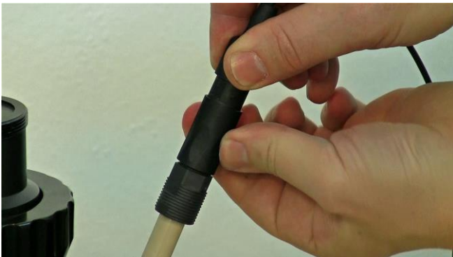
Figura 3.7-13 Después de fijar el electrodo de pO_2 (OD) y el conector en la posición exacta de cierre, empuje hacia abajo la cubierta del conector del electrodo de pO_2 (OD) y asegúrelo suficientemente enroscándolo.
