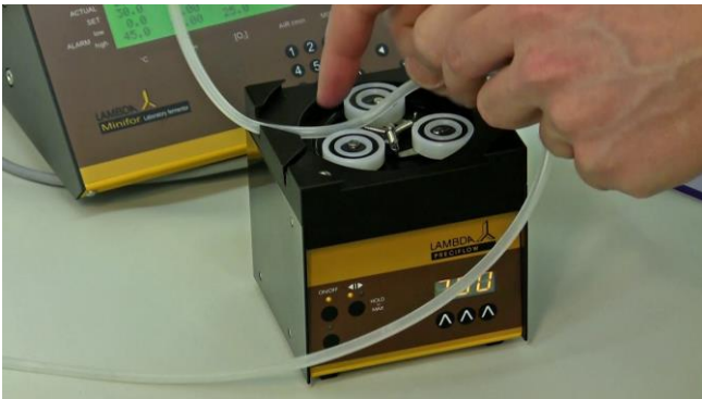
Figura 7.1—13 Retire las tuberías o mangueras para el ácido y la base de las bombas peristálticas.
