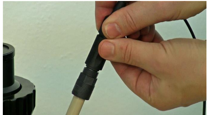
Figura 3.7-12 Coloque y ajuste el conector del electrodo de pO_2 girándolo o rotándolo para encontrar la posición exacta para el cierre de ranuras y cavidades con el electrodo de pO_2 .
