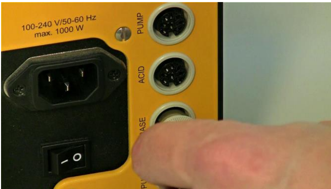
Figura 3.16-16 Conecte el cable de la bomba peristáltica para la adición de base en el enchufe o conector "BASE" ubicado en la unidad principal de control del MINIFOR.
