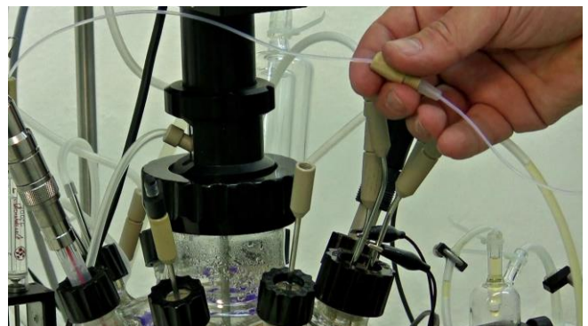
Figura 3.14-26 La tubería o manguera de PTFE para el antiespumante tiene que ser conectada a la cánula más corta para facilitar la adición de antiespumante por encima del nivel del líquido.
