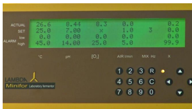
Figura 5.3-15 La medición del O 2 en el medio / líquido saturado se mostrarán en el valor real del parámetro [O 2 ].
