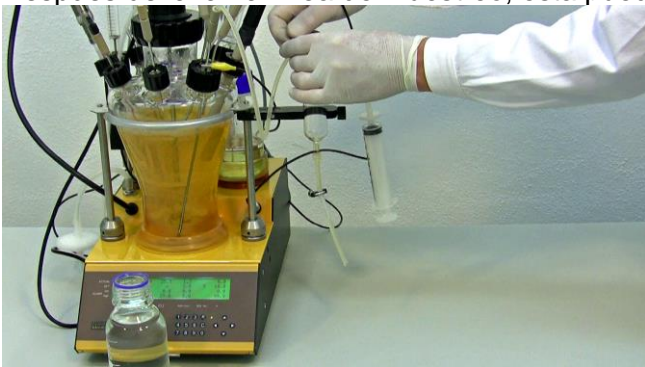
Figura 8.2—9 Abra la pinza en la entrada del puerto de muestreo (es decir, entre el MINIFOR y el dispositivo de toma de muestra).
