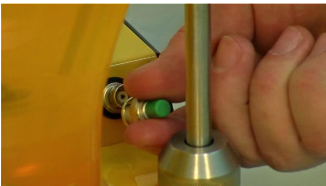
Figura 3.15-19 Retire la tapa protectora presionando y girando o rotando en el enchufe o conector del electrodo de (OD) ubicado en la unidad principal de control.
