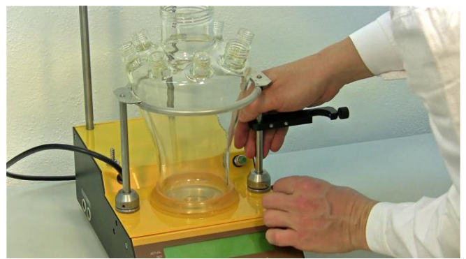
Figura 3.4-12 Apriete la varilla del sujetador del otro orificio para que de esta forma el equipamiento quede seguro. (Nota. Si necesita utilizar el dispositivo de muestreo estéril puede unir el sujetador al ej., apoyo colocado hacia la mano derecha)
