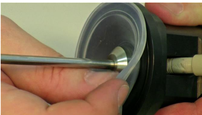
Figura 3.5-19 Asegúrese de que la membrana para mantener la esterilidad de silicona se ajuste y quepa firmemente en las ranuras o cavidades de la cabeza (cabezal o parte superior) de la unidad de agitación.
