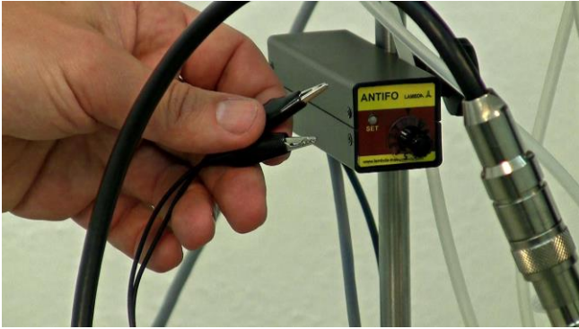
Figura 3.15-27 Las dos pinzas de tipo cocodrilo del ANTIFO necesitan ser conectadas con las cánulas del puerto de muestreo cuádruple para la detección de nivel de espuma en el vaso de reacción.
