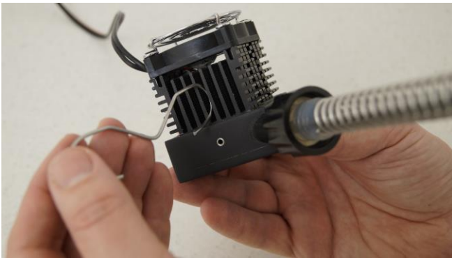
Figura 3.12-10 La celda Peltier unida con el dedo de condensación debe ser mantenida unida con ayuda de una pinza de cierre.
