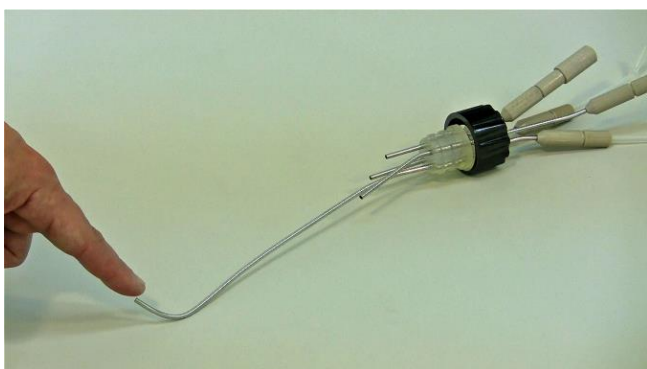
Figura 3.14-3 La aguja de cosecha del puerto de muestreo cuádruple (la cual alcanza el fondo del vaso) es usada como medio de contacto.
