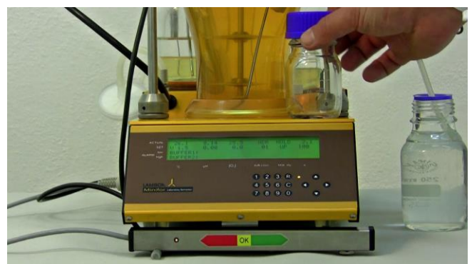
Figura 5.5-6 Coloque un peso conocido sobre la unidad principal de control del MINIFOR. Por ejemplo, coloque una botella de vidrio vacía.
