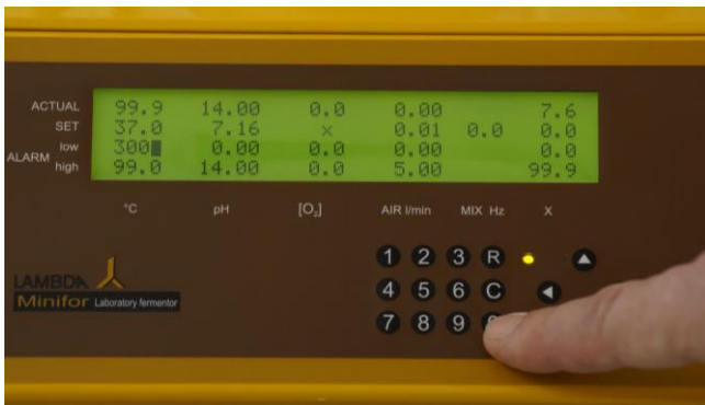
Figura 4.3-3 Mueva el cursor sobre el campo de la temperatura mínima (ALARMA BAJA). Introduzca el valor deseado. Si la temperatura cae por debajo de este valor, se activará una alarma y aparecerá un asterisco a la izquierda del valor correspondiente.
