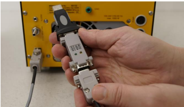
Figura 6.4—3 Conecte el convertidor de RS-485 a RS-232 al otro extremo del cable de conexión del ordenador o computadora.
