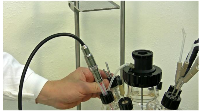
Figura 3.11-4 Asegúrelo y apriételo gentilmente con la tapa negra con rosca.
