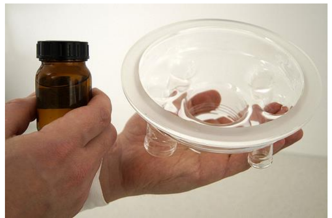
Figura 3.4-26 Aplique una pequeña cantidad de aceite de silicona en la parte superior del vaso para el retiro fácil de las partes después de finalizar el experimento.
