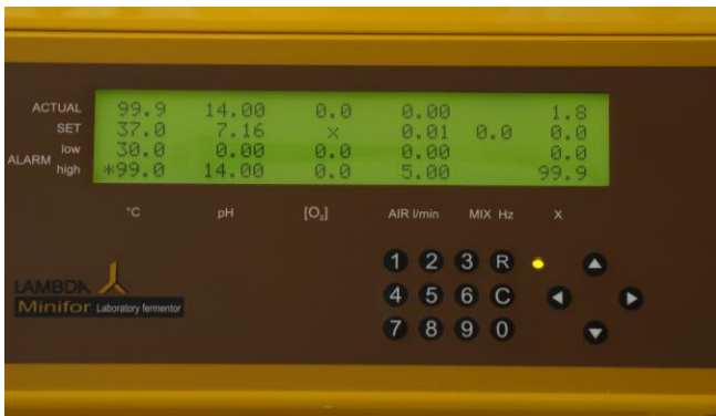
Figura 4.3-6 La alarma alta se activa. * La señal puede ser vista con el valor de alarma alta.
