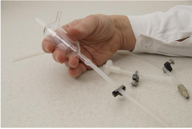
Figure 3.10-19 Tuberías de silicona de 10-20 cm de largo necesitan ser conectadas al brazo de acceso de salida en el dispositivo de vidrio ej., el brazo vertical opuesto a la conexión de muestreo de entrada con el biorreactor (en la parte más baja del dispositivo).
