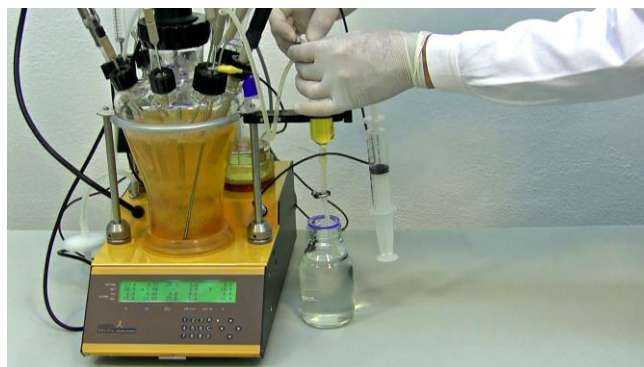
Figura 8.2—4 Cierre la pinza en la tubería o manguera de entrada para evitar la circulación inversa de la muestra en el vaso de reacción.
