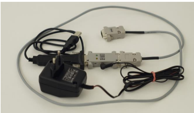
Figura 3.15-38 Kit de conexión del ordenador o computadora con convertidor de RS-232 a R-485 y la conexión USB.
