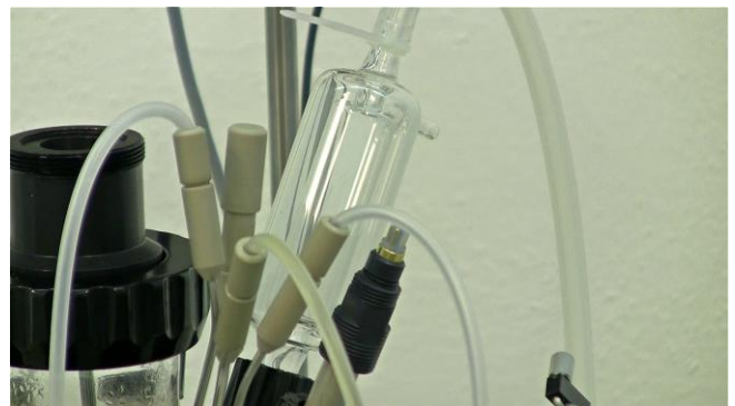
Figura 7.1—12 Pince todas las tuberías o mangueras y la línea de entrada de aire, excepto la línea de salida de aire con el condensador del gas de salida y el filtro de salida.
