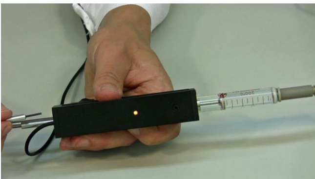
Figura 5.6-9 Cuando el DOZITO recibe la señal del ANTIFO, el LED o indicador se iluminará en amarillo y la varilla de empuje empujará el émbolo de la jeringuilla y por lo tanto libera el volumen preestablecido o prefijado del agente antiespumante.
