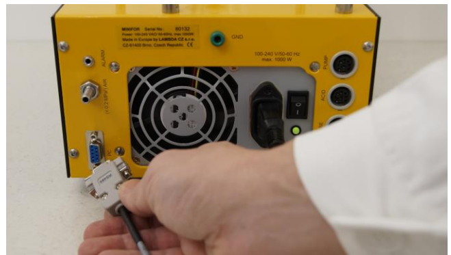
Figura 3.15-39 Conecte el cable de conexión del ordenador o computadora al conector DB 9 ubicado en la parte posterior o trasera de la unidad principal de control.
